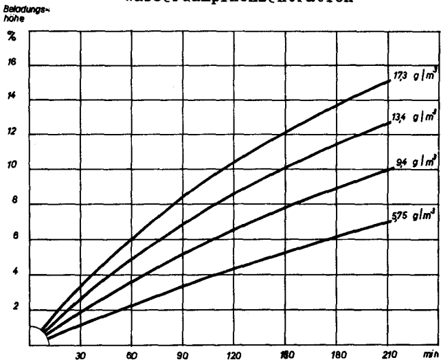
Fig. 27 Beladungskurven bei variabler Wasserdampfkonzentration
