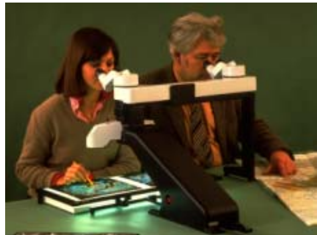
Abb. 5.4: Aviopret APT1 von Leica
