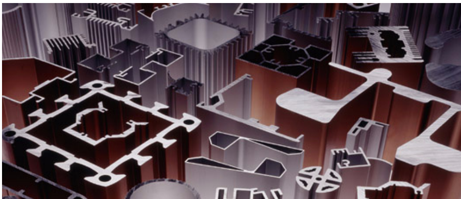
Bild 2.10 Beispiele einiger durch Strangpressen hergestellter Querschnitte aus Aluminium (ALMAG Aluminium (2008))
