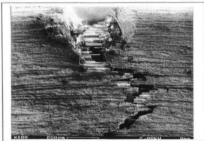
Abbildung 26: Rißverlauf in einer gekerbten keramikfaserverstärkten Aluminium Probe (100-fach).
