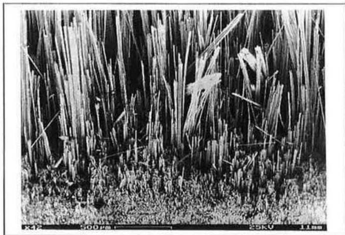
Abbildung 15: Bruchfläche von kohlefaserverstärktem Kohlenstoff (42-fach). Im Vordergrund Knickzone im Druckbereich der Probe.
