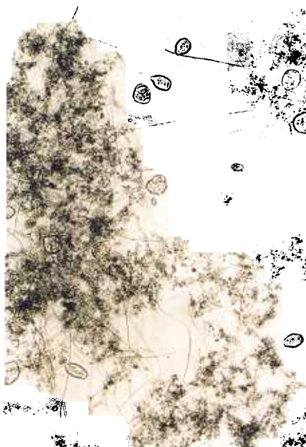
Abb. 5: Biozönose einer überlasteten konventionellen Biologie
