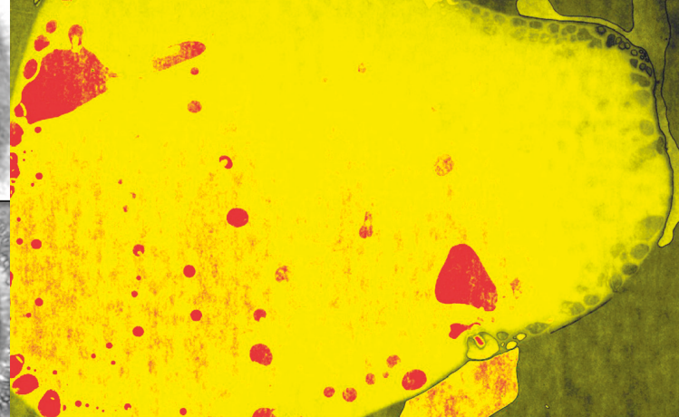
Abb.: Verklebung mit Luftschlüssen
