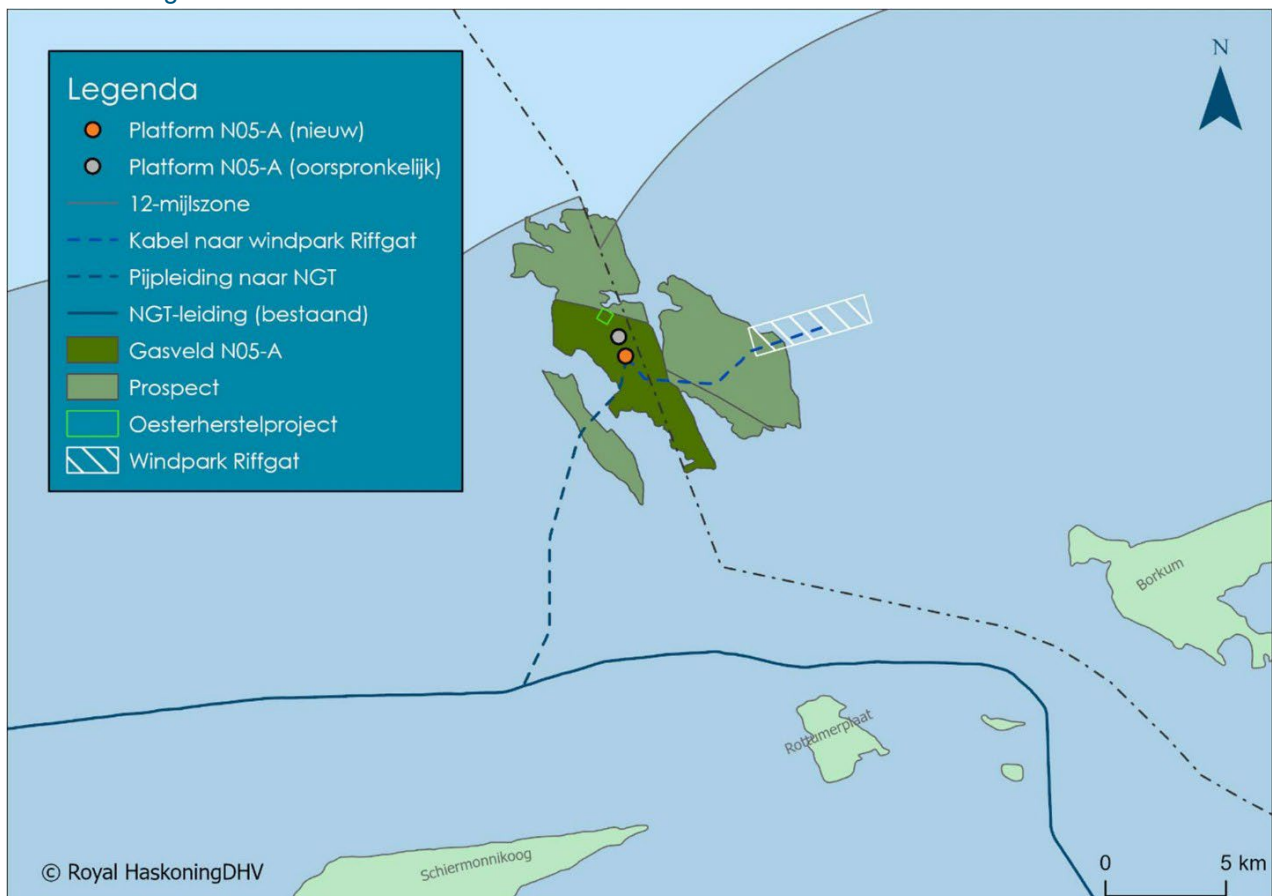
Abbildung 3-1: Ursprünglicher und neuer Standort der Förderplattform, einschließlich der Lage der Gasfelder und der neuen Abschnitte der Gaspipeline und des Kabels zum Windpark Riffgat.
