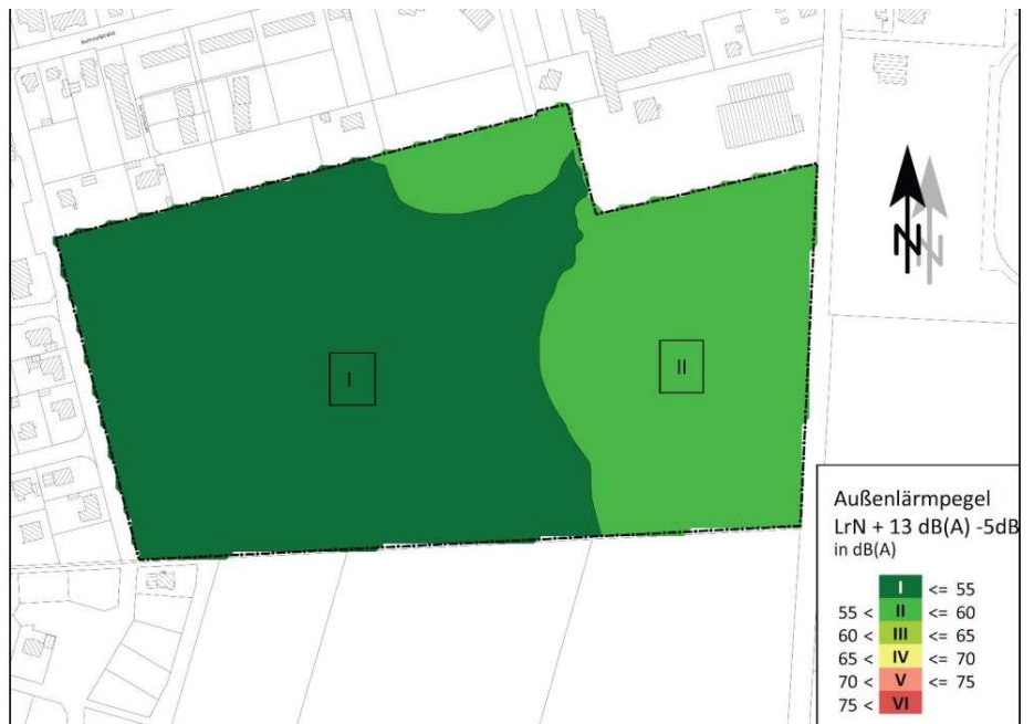
Abbildung 7: Lärmpegelbereiche zum Schutz vor Schienenverkehrslärm
