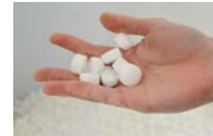
Bilder unten: Mittels einer Wasseraufbereitungsanlage wird das Brauchwasser speziell für die hohen Anforderungen im Krankenhausbetrieb gefiltert. Anders als herkömmliche Wasserfilter arbeitet diese Anlage auf Molekularbasis und kann auch gelöste Stoffe aus dem Wasser entnehmen. Mit Hilfe von Natriumchlorid, in Form von Salztabletten, wird das Tauscherharz in den blauen Drucktanks regeneriert.
