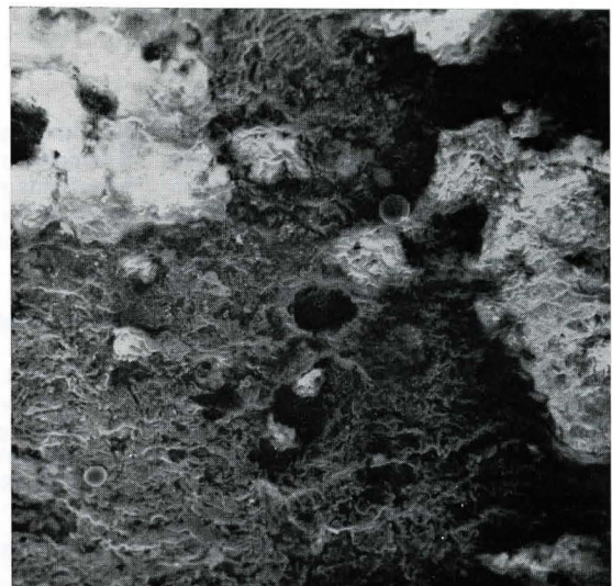
Bild 3. Sonderstahl X 20 CrMoV 12 T (C) PVC-hart* (b) (siehe Tab. 5), Vergrößerung 550:1.
