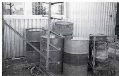
„Leere“ Fässer sind nicht leer! Wenn sie ungeschützt der Witterung ausgesetzt werden, können sie leicht von innen und von außen durchrosten.
