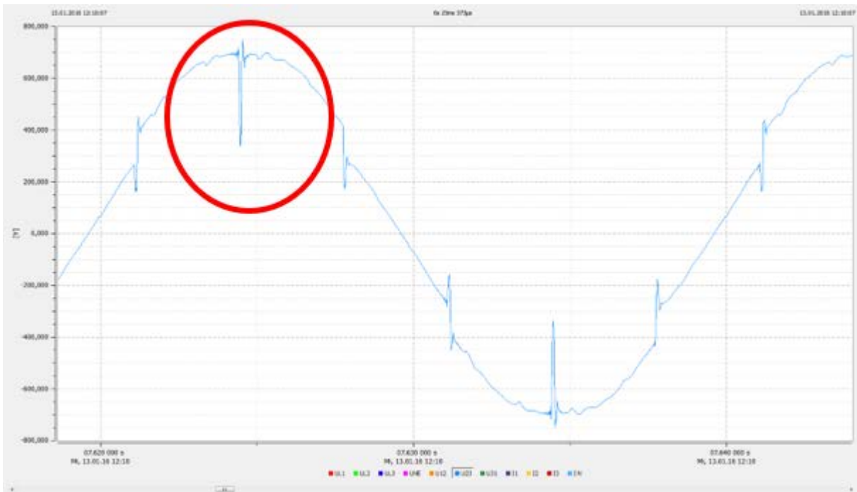
Abbildung 67: Beispiel 2, verkettete Spannung U23 mit Sample-Rate > 10 kHz
