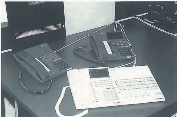
Linienwähler Telepax DX Als neueste Anlage von Telepax gibt es das DX-System. Es ist digital und offeriert im Endausbau 36 Amts- und 100 Internanschlüsse.
