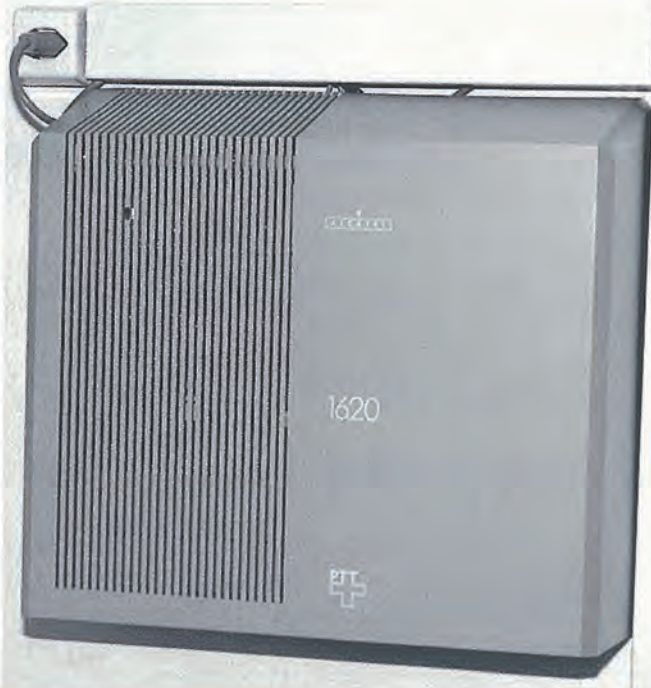
Alcatel 1620 max. Ausbau 12 Amts- und 18 Zweiganschlüsse oder 9 Amts- und 24 Zweiganschlüsse
