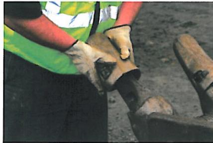
**Schritt 5:** Wenn die Spitze gelockert ist, ziehen Sie sie von der Nase ab.
