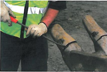
**Schritt 4:** Bei einigen Anwendungen behindern komprimierte Feinteile das Abnehmen der Spitze. Setzen Sie das Stemmeisen hinter der Spitze an, um diese zu lockern.
