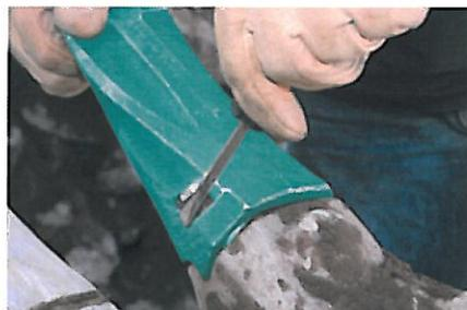
**Schritt 8:** Setzen Sie das Stemmeisen an der Unterseite des Keils in seitlich im Zahn an. Drücken Sie das Stemmeisen zur Mittellinie der Spitze, bis der Keil einrastet. Erst wenn Sie ein merkliches Klickgeräusch hören, sitzt der Keil richtig.
