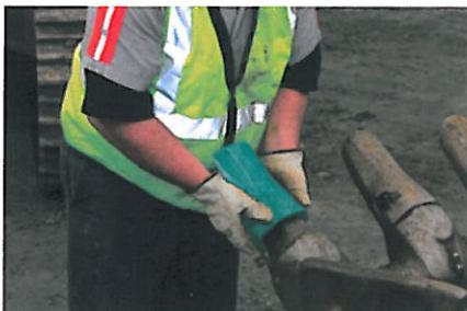
**Schritt 7:** Bringen Sie die neue Spitze auf der Nase an. Achten Sie darauf, dass der Keil sich vor dem Einbau in der freien Position befindet.
