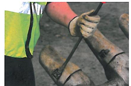
**Schritt 3:** Setzen Sie das Stemmeisen in der zweiten Kerbe an und drücken Sie den Hebel erneut in Richtung Mittellinie der Spitze, bis alle drei Kerben sichtbar sind. **Der Keil ist in diesem Moment noch mit der Spitze verbunden.**
