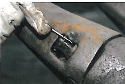
**Schritt 1:** Entfernen Sie Feinteile aus den Hohlräumen an der Ober- und Unterseite des Keils.
