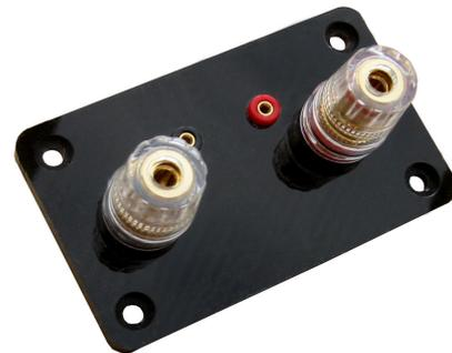
LS Anschlußterminal auf 5 mm Acryl-Platte mit isolierten Polklemmen. Zwei zusätzliche 2mm Bananenbuchsen erlauben getrennten Anschluß der Treiber (TT & HT f. externe Weiche) bzw. der Filterzweige (Bi-Amping / Biwiring). Die zusätzlichen Buchsen können auch für eine Schaltfunktion, wie Pegelabsenkung des Hochtöners o.ä. genutzt werden
