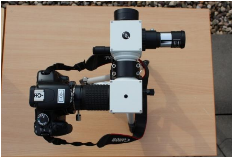
Abbildung 31: Aufbau des Dados-Spektrographen mit EOS-Kamera 11
