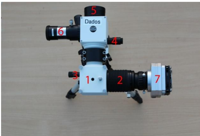
Abbildung 32: Aufbau des Dados-Spektrographen mit ALccd-Kamera 12
