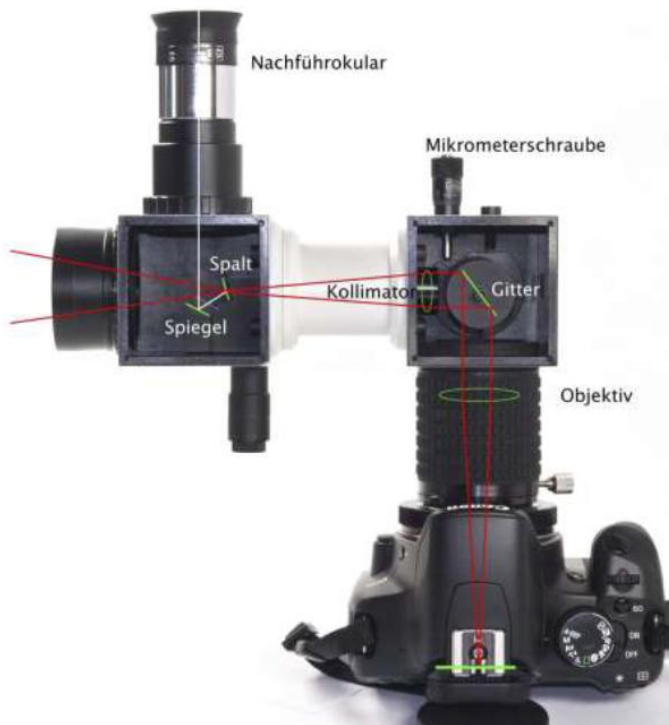
Abbildung 33: Strahlengang im DADOS-Spektrographen 16
