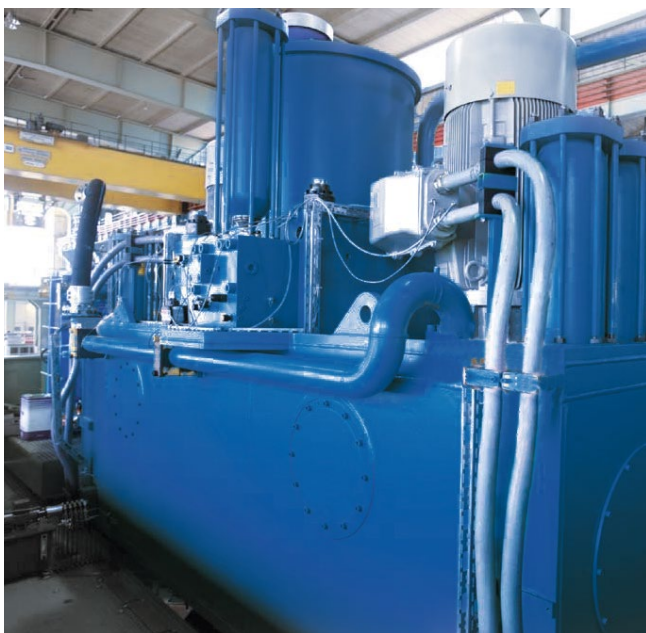
Antriebskopf eines hydraulischen Gegenschlaghammers.
