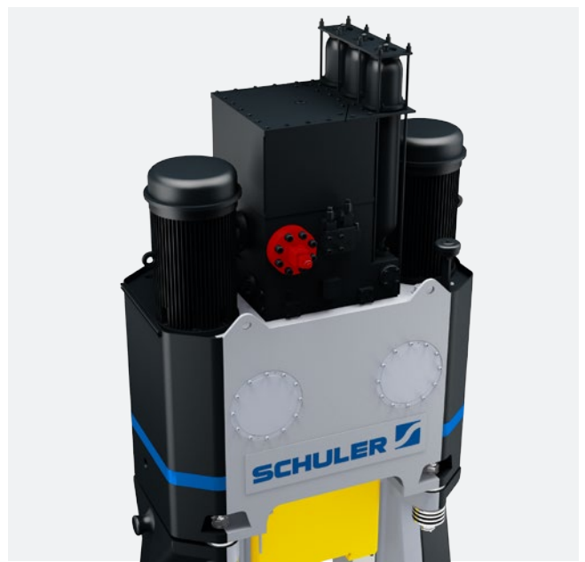
Steuerblock mit Proportionalventil.
