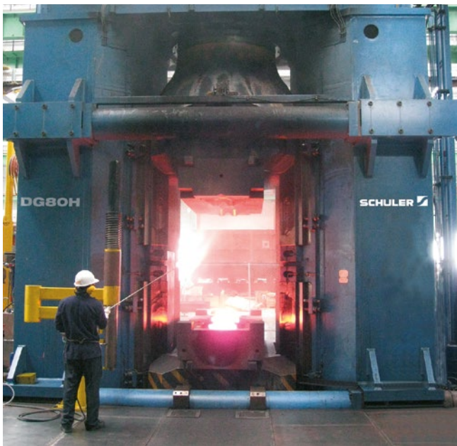
Gegenschlaghammer mit einem Arbeitsvermögen von 800 kJ.
