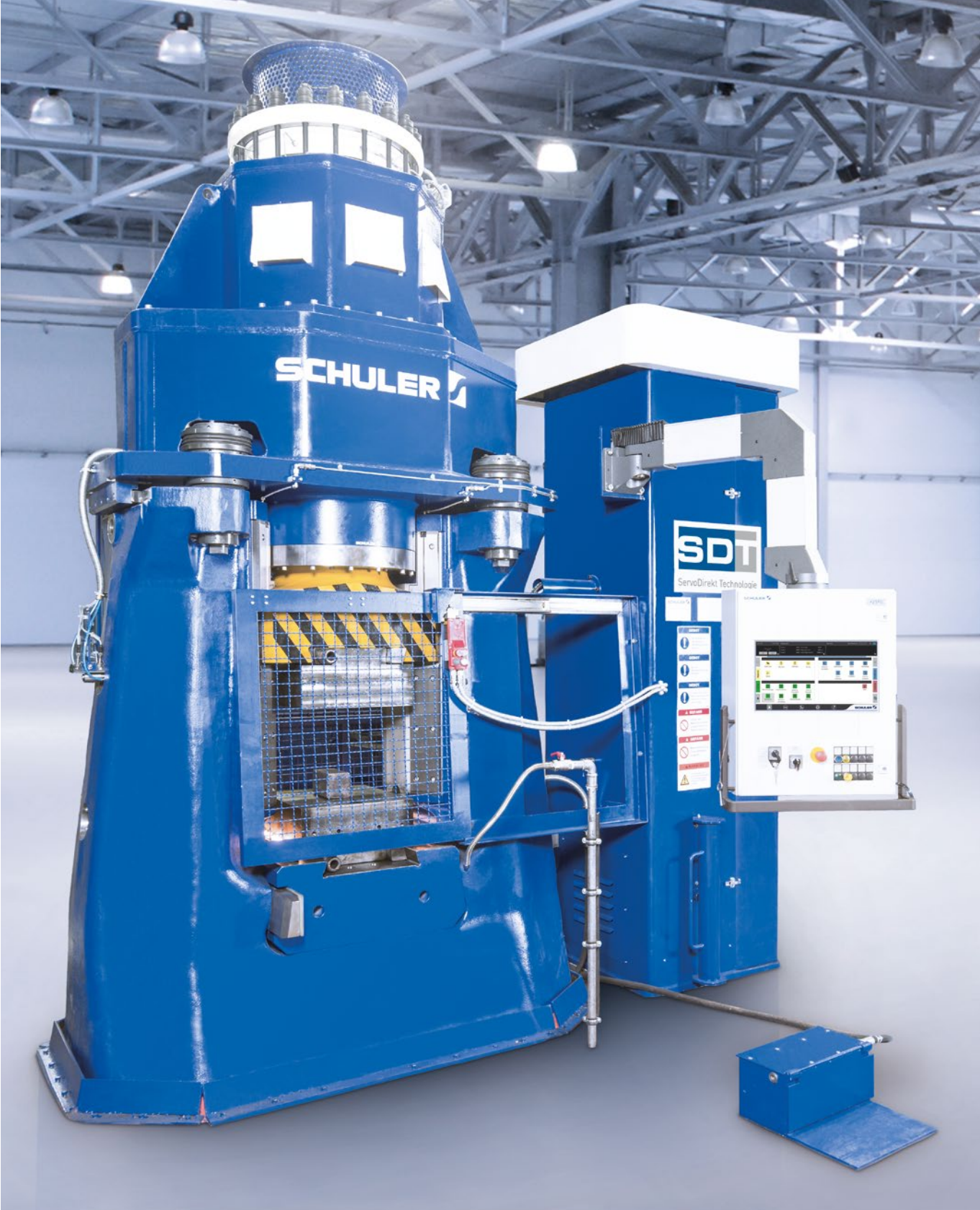
Linearhammer mit ServoDirekt Technologie.
