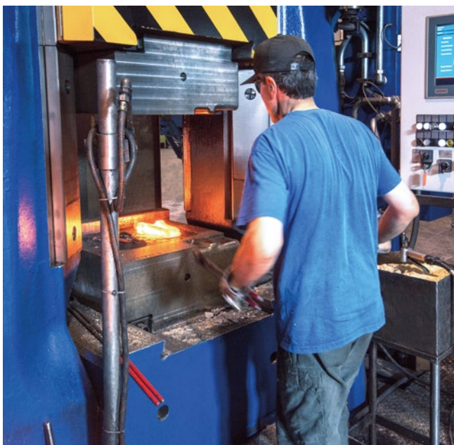
Oberdruckhammer KGH 4 mit Proportionalventiltechnik im Schmiedeeinsatz.
