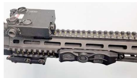
Neue intelligente Zubehörschiene T-Worx der U.S. Army.
