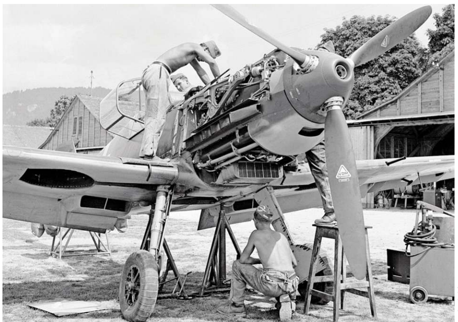
Mechaniker warten im Aktivdienst im Thun eine Messerschmitt BF 109-E.
