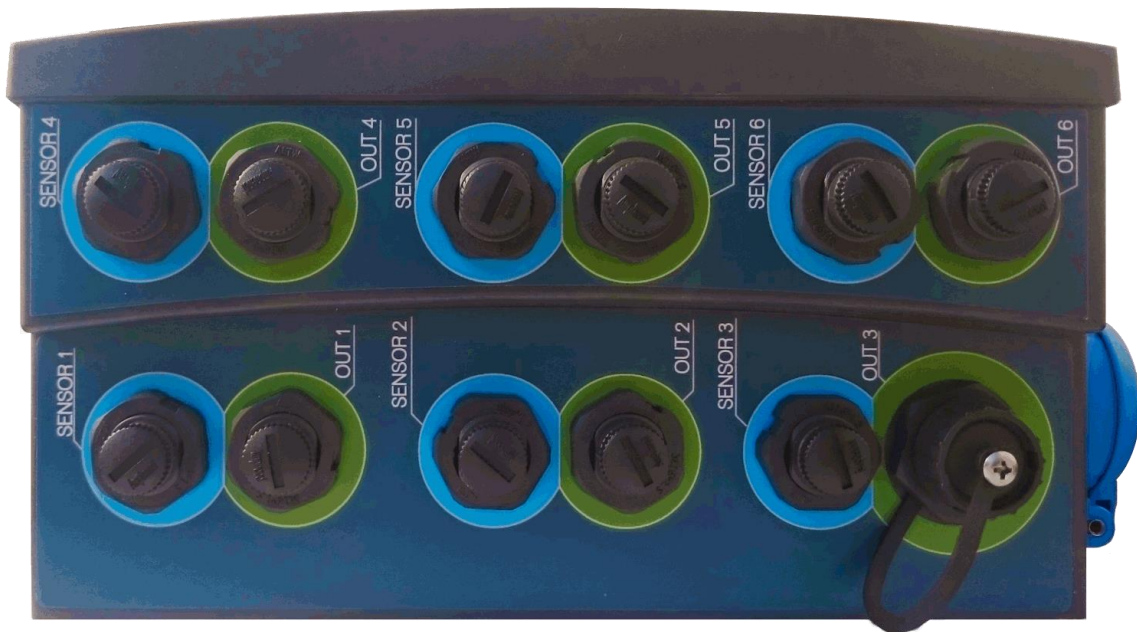
Abbildung 3: Sensoren-Anschlüsse und Aktoren-Ausgänge der AQUACULTURE|CONTROL Pro.
