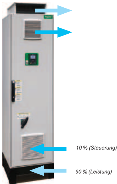
Kühlsystem mit 2 separaten Luftströmen
