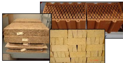
Fig.7 Exemplu de caramida ceramica cu goluri, cu proprietati excelente de izolare Fig.8 Exemple de caramizi din argila
