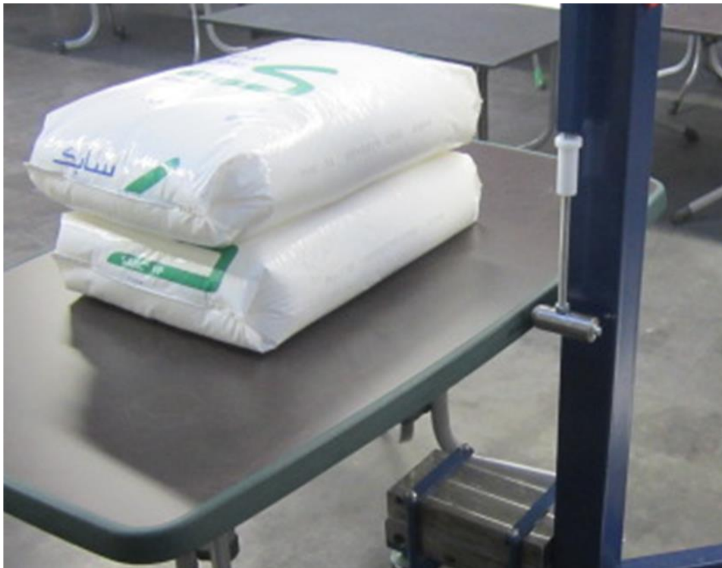
Schlagtest um die Stabilität der Tischkante zu prüfen
