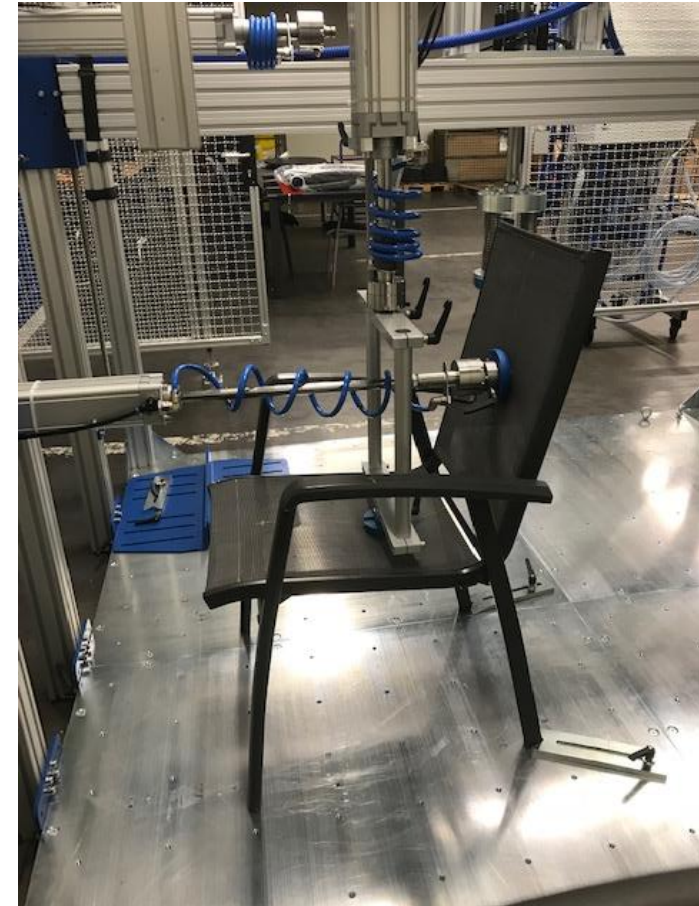
Prüfung der Belastbarkeit Rückenlehne
