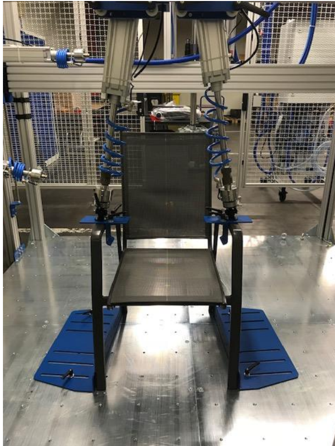
Prüfung der Belastbarkeit Armlehne
