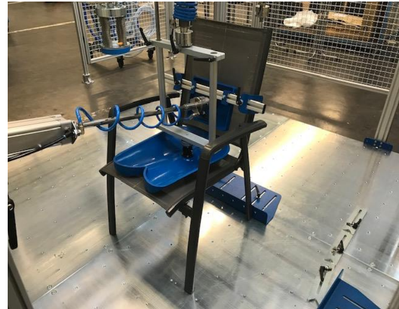
Prüfung der Belastbarkeit Sitz- und Rückenfläche
