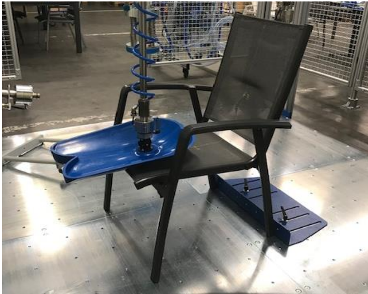
Prüfung der Standsicherheit vorne
