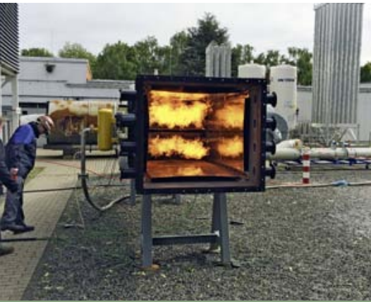
Teststrecke für den neuen Flächenbrenner im Außenbereich eines Duisburger Instituts
