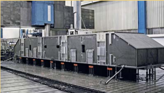
Oberholm in der spanenden Bearbeitung in Krefeld
