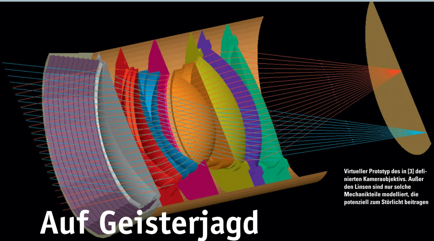
Virtueller Prototyp des in [3] definierten Kameraobjektivs. Außer den Linsen sind nur solche Mechanikteile modelliert, die potenziell zum Störlicht beitragen
