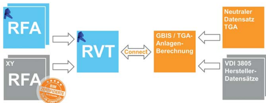
Original- und zertifizierte Revit-Familien (RFA-Dateien) lassen in ein Revit-Projekt (RVA-Datei) einlesen und im Verbund mit SOLAR-COMPUTER-Berechnungen mit neutralen und/oder VDI 3805-Datensätzen kombinieren, z. B. für eine produktneutrale Vorplanung für die Ausschreibung und eine fabrikspezifische Ausführungsplanung nach Vergabe.
