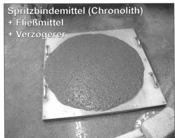
Bild 6: Konsistenz - Nassspritzbeton mit SBM
