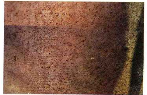
Abb. 8 Korund aus dem Umba-Tal (Tanzania) mit Einschlüssen von braunen Hämatit-schüppchen, die ihm seine Farbe verleihen.
