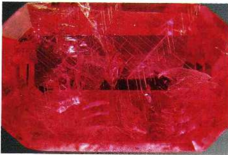
Abb. 4 Rubin mit stabförmigen Einschlüssen: Schnittkanten von sich schneidenden Zwillinglamellen. Dieses Merkmal tritt in Rubinen der meisten Vorkommen auf.
