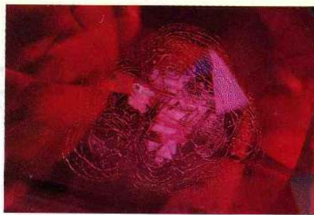
Abb. 5 Künstlich verheilte Rißebene mit trigonalen Rippenstrukturen. In den flachen dreieckigen Hohlräumen sind Reste der glasigen Schmelze, die an einigen Stellen zu weißen Büscheln auskristallisierte.
