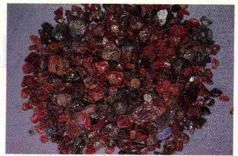
Abb. 7 Rohe Korundkristalle und Bruchstücke aus dem Umba-Tal (Tanzania). Sie zeigen, entsprechend Art und Gehalt an färbenden Spurenelementen, ganz verschiedene Farben.
