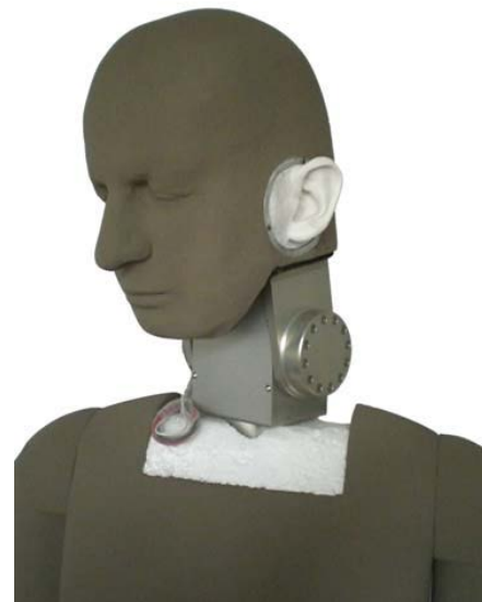
Abbildung 74: Messsystem FABIAN zur Akquise binauraler Raumimpulsantworten [74, Abb. S. 3]
