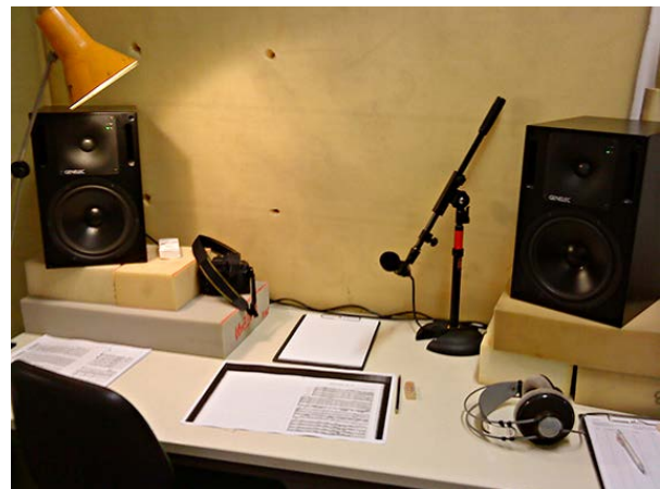
Abbildung 85: Regieplatz im Kontrollraum zum Abhören der Aufnahmen und Kommunizieren mit den Künstlern im reflexionsarmen Raum über Talkback
