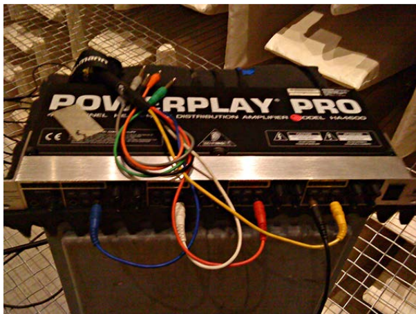
Abbildung 84: Kopfhörerverstärker Behringer Powerplay Pro HA-4600 zum individuellen Kopfhörer-Mix für jeden Künstler
