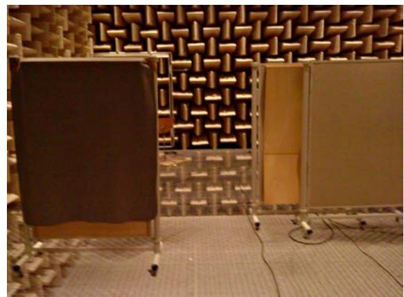
Abbildung 79: Separierung der Musiker durch decken-behängte Stellwände im reflexionsarmen Raum
