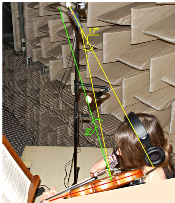
Abbildung 83: Mikrofonierung von Violine 1 (VI 1) mit passenden Abstands- und Winkeleinstellungen; Seite
