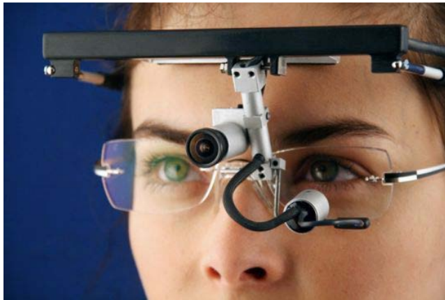
Abbildung 30: Eyetracker; dient der Erfassung von Blickbewegungsverläufen [30]
