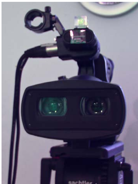
Abbildung 97: Frontansicht des verwendeten Panasonic AG-3DA1 Camcorders mit parallel zueinander ausgerichteten Objektiven
