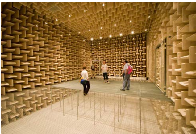
Abbildung 78: reflexionsarmer Raum des Instituts für Technische Akustik an der TU Berlin [80, Abb.].
