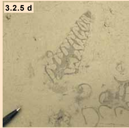
Abb. 3.2.5 d Turmschnecke (mit >> feinem Sediment gefüllt, vertikal angeschnitten) in Chandore Kalkstein (O Kreide, Frankreich) Berlin, Friedrichstraße 69 - 71, Fußbodenplatte
