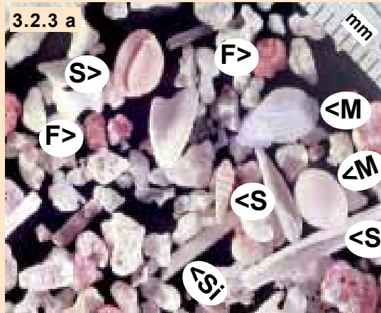
Abb. 3.2.3 a Biogene Karbonate: Rezentes Flachwasser- Sediment (Bermuda-Inseln) aus Kalk-Skelett- Teilen, u.a. von M - Muscheln, S - Schnecken, Si - Seeigeln F - sessilen Foraminiferen = Einzeller)
