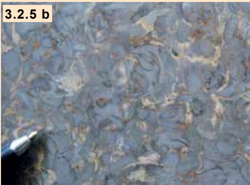
<< Abb. 3.2.5 b Muschelschill aus dem Kirchheimer Muschelkalk (M Trias, Bayern) Berlin, TU. Erweiterungsbau, Wandverkleidung)
