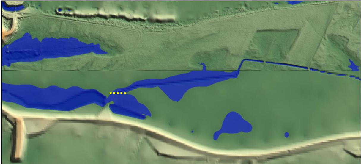
Abb. 84 Die blau schraffierten Flächen mit Geländehöhen unter 3,6 mNHN werden bei Rückbau der Rückstauklappe bei entsprechend hohem Tidehochwasser überschwemmt, durch die Errichtung einer Verwallung (gelbe Linie) werden die deichnah gelegenen Stillgewässer erst bei Thw > +3,6 mNHN angeschlossen.
