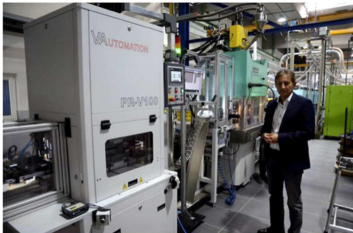
Geschäftsführer Selahattin Servi an einer der automatisch arbeitenden Maschinen im Bereich Spritzguss. Hier werden gestanzte Artikel mit Kunststoff umspritzt. Foto: Hammes
