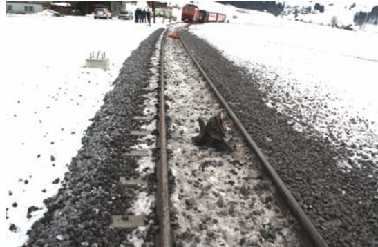
Abgeschlagene und durch den Zug mitgeschleppte GF-Kupplung
