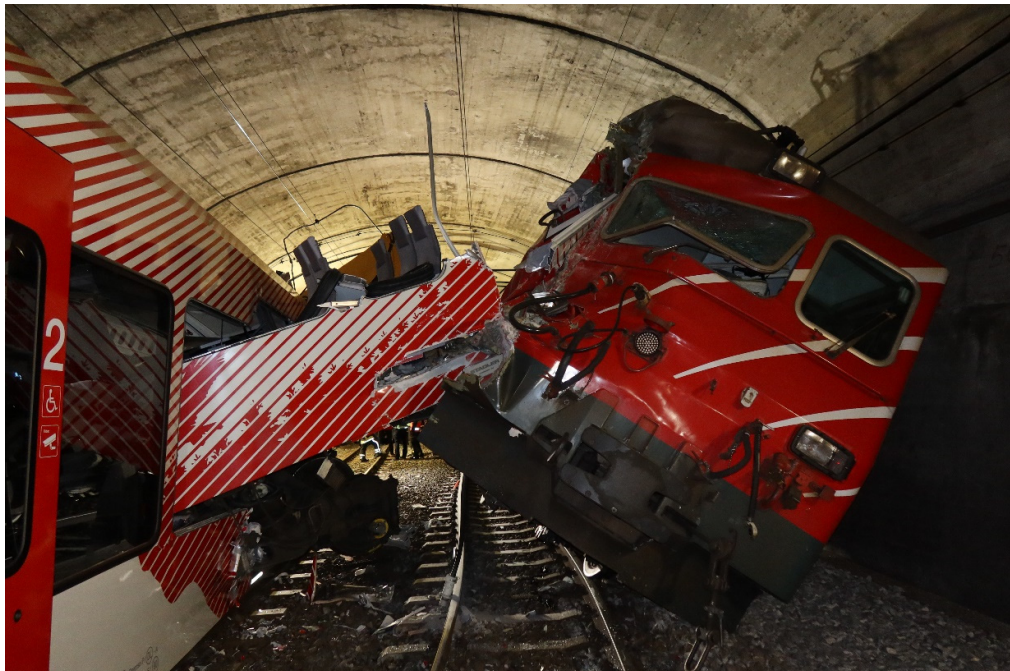
Abbildung 4: Fotografie der Unfallstelle. Rechts die Lok des Autozuges, links der Niederflurwagen des Regionalzuges.
