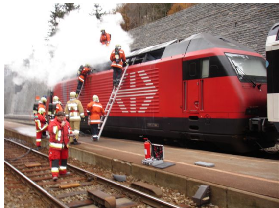
effiziente Brandbekämpfung nach Demontage der Dachlüftungsgitter
