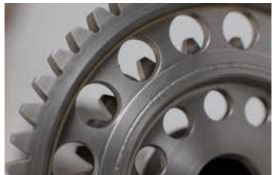
Abb. 5: Einzelne Zahnräder wurden axial im Nabenbereich verzugsarm gefügt und dabei ist eine Rundlauf-toleranz von 0.05mm eingehalten worden.
