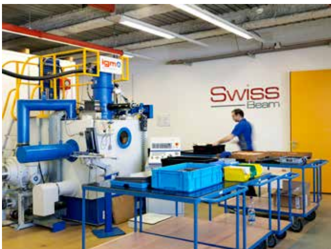
Abb. 9: Eine von zwei Elektronenstrahlschweissanlagen bei SwissBeam
