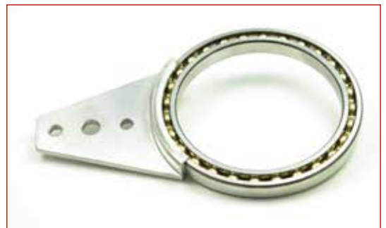
Abb. 7: Ein einfacher Stahlhalter wird am Aussenring eines Standard – Kugellagers, auf der Vorder- und Rückseite verschweisst. Vorteile: Wesentliche Kosten- und Gewichtseinsparungen und dabei werden die Laufeigenschaften des Kugellagers gewährleistet
