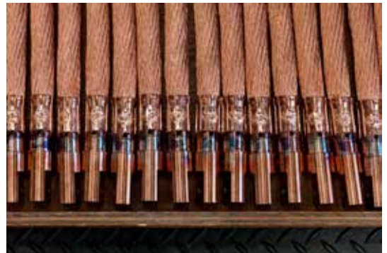
Abb. 4: Kupferkabelanschlüsse sind in einem Arbeitsgang 25mm tief verschweisst worden
