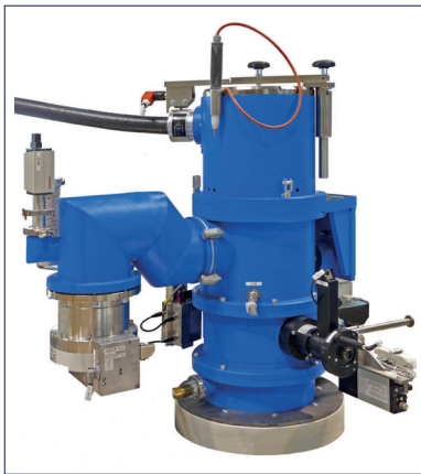
Bild 2: Das Herzstück jeder Elektronenstrahlschweißanlage ist der Generator
