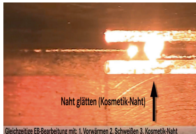
Bild 11: Die ersten beiden Strahle wärmen das Werkstück vor, da zwischen wird geschweisst und im Anschluss erfolgt eine Kosmetiknaht
