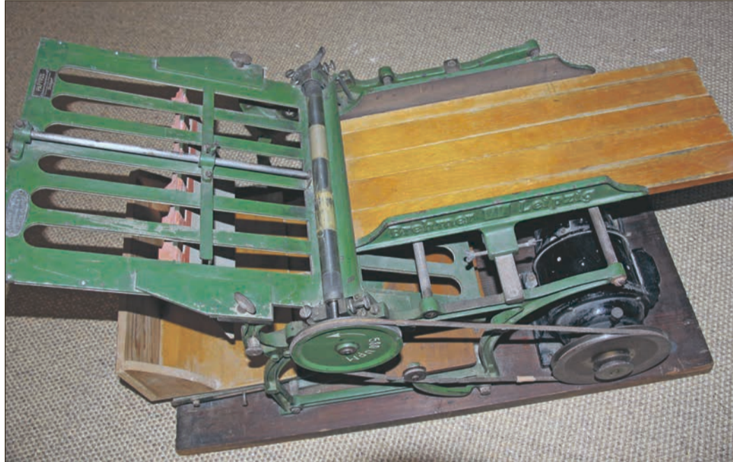
Die „Falzmaschine“ erleichterte in den ersten Jahren das zusammensetzen der KöWos aus einzelnen Druckbögen, die jeweils in der Mitte geknickt werden mussten. Rechts dazu noch zwei Detailaufnahmen für Liebhaber alter Technik.
