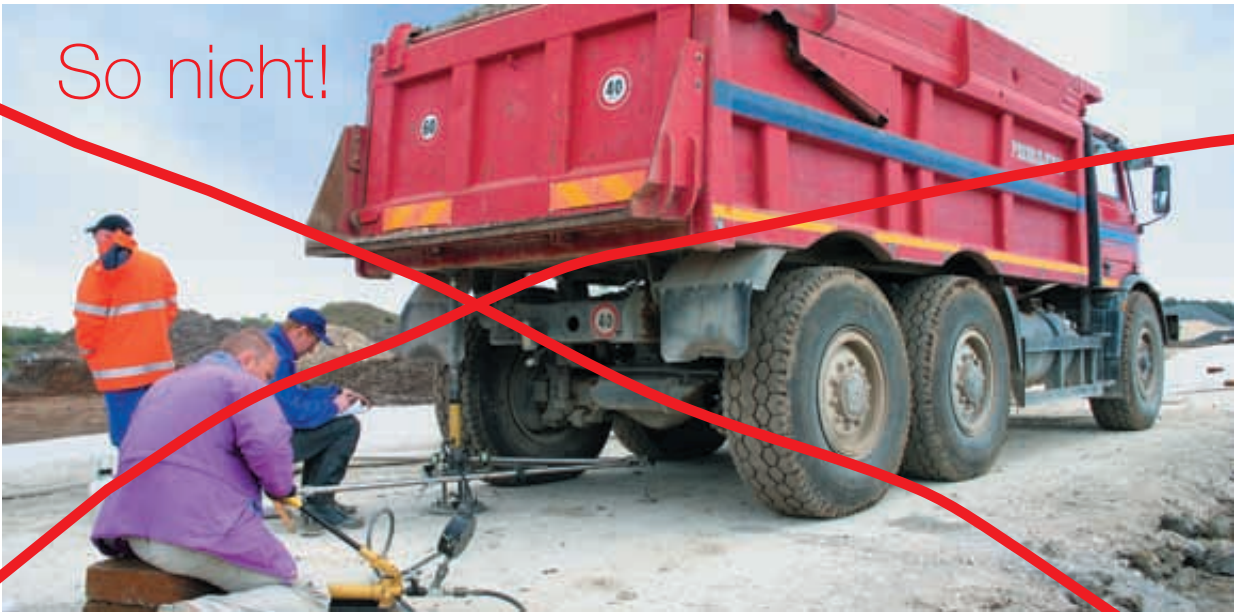
So nicht: Statischer Lastplattendruckversuch mit Belastungsfahrzeug, zeitaufwendig und unwirtschaftlich.
