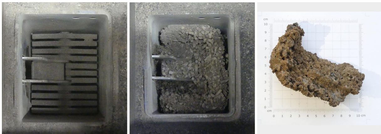
Abbildung 39: Kipprost des Pelletkessels (links: leerer Kipprost; Mitte: deutliche Verschlackung und hohes Aschebett auf dem Kipprost nach Abbruch eines Feuerungsversuchs [vor der Rostreinigung]; rechts: einzelner Schlackebrocken auf Millimeterpapier [10 × 10 cm])
