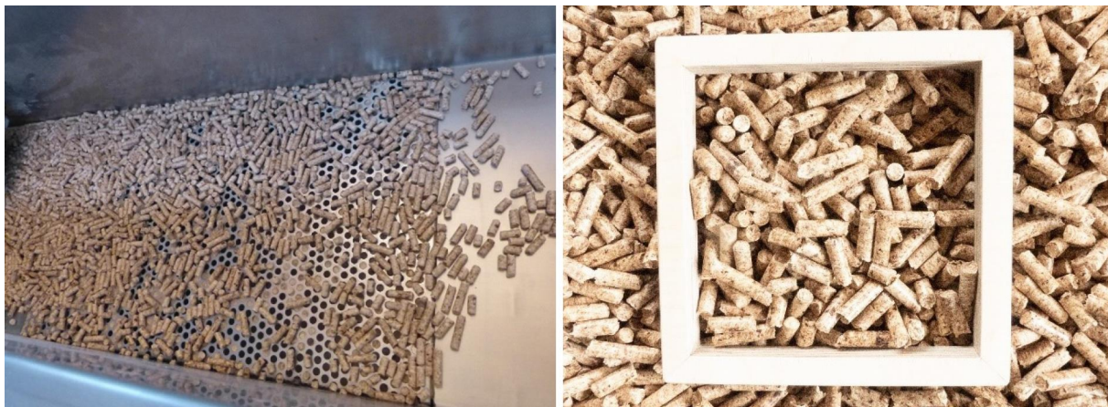
Abbildung 26: Herstellung von Pelletbrennstoffen am TFZ (links: automatische Siebung der produzierten Holzpellets mit einem 6-mm-Rundlochblech; rechts: produzierte Fichtenpellets [Nullprobe], 10 × 10 mm Holzrahmen)
