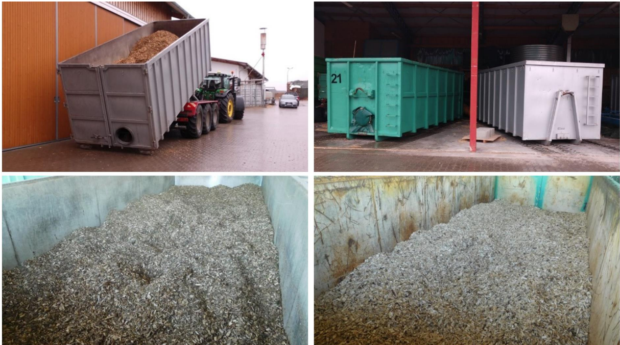
Abbildung 16: Trocknung der Versuchsbrennstoffe in der Holzhackschnitzeltrocknung (oben links: Verbringen der Trocknungscontainer auf dem Betriebsgelände; oben rechts: Container an Trocknungsanlage angeschlossen; unten links: fertig getrocknete Waldrestholzholzhackschnitzel; unten rechts: fertig getrocknete Energierundholzholzhackschnitzel)
