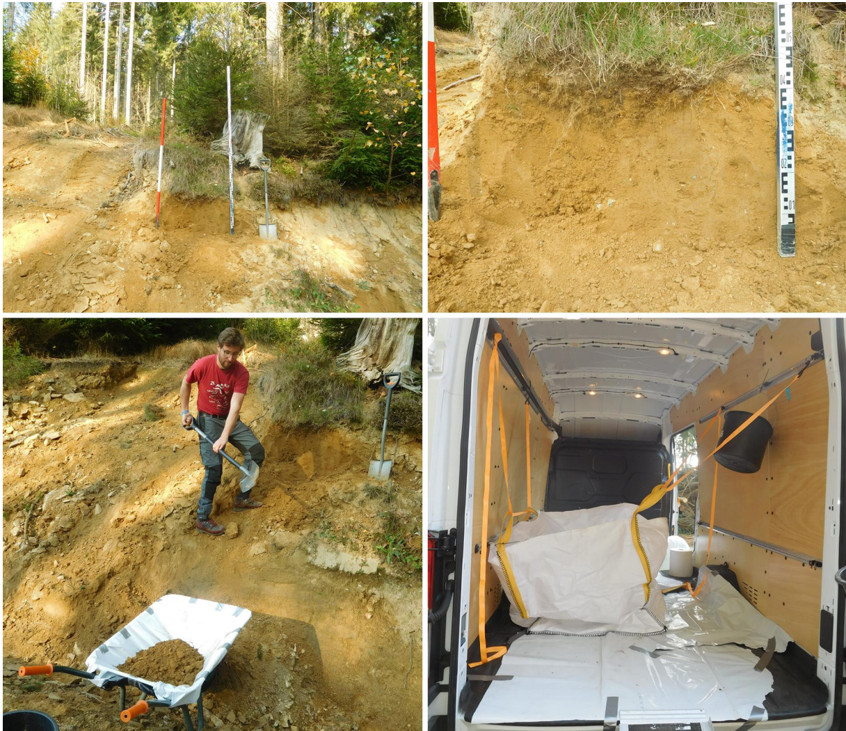
Abbildung 12: Mineralbodenbeschaffung (links oben: Erweiterung des Geländeanschnitts; rechts oben: Detailansicht Bodenprofil; links unten: Hilfskraft bei der Bodenmaterialgewinnung; rechts unten: mit Folie ausgekleideter Transporter zur Lieferung des Bodens an das TFZ)
