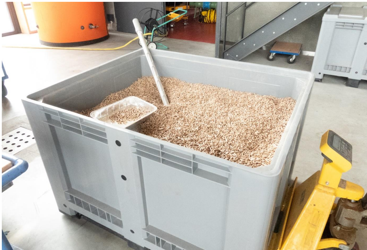
Abbildung 30: Probenahme von Holzpellets mittels Probenlanze nach DIN EN ISO 18135
