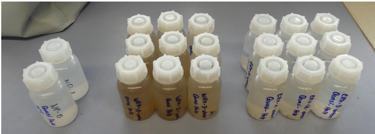
Abbildung 68: Proben zur inhaltsstofflichen Analyse an der LWF (links: Doppelbestimmung des Leitungswassers; Mitte: Waschwasser des WRH, jeweils drei Proben pro Durchgang; rechts: Waschwasser des ERH, jeweils drei Proben pro Durchgang)
