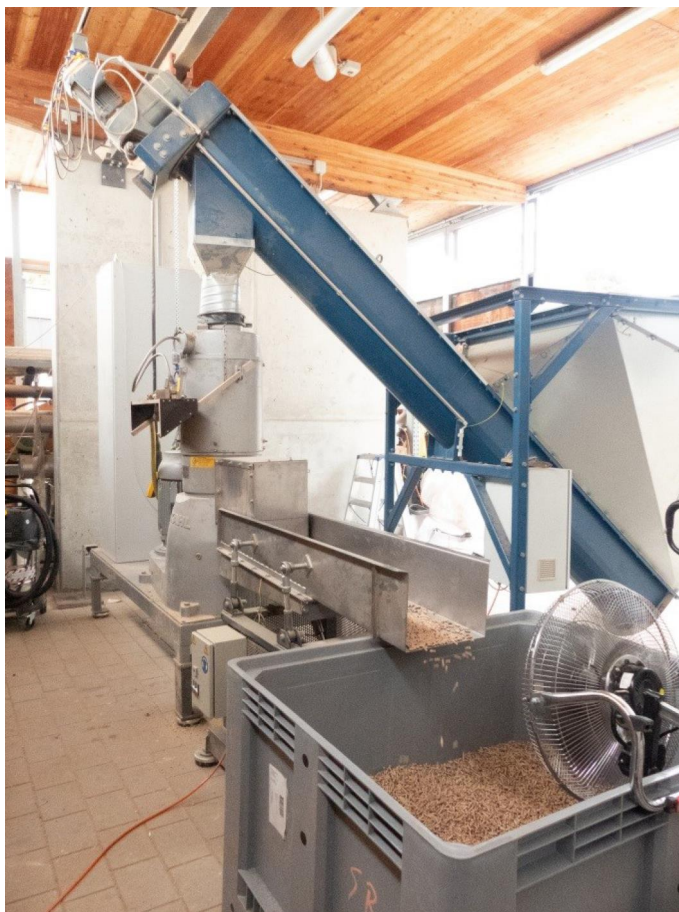
Abbildung 23: Pelletieranlage (Amandus Kahl GmbH & Co. KG, Typ 33-390) am TFZ mit Materialzufuhr und Rüttelsieb (links) und schematische Darstellung eines Presskanals einer beidseitig nutzbaren Flachmatrize (rechts)
