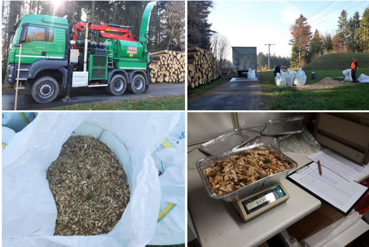
Abbildung 10: Vorgehen bei der Holz hackschnitzelbeschaffung (links oben: Lkw-Aufbautrommelhacker JENZ Chippertruck HEM 593; rechts oben: In Bigbags abgefüllte Holz hackschnitzelproben werden in bereitstehenden Lkw verladen; links unten: mit Holz hackschnitzeln aus Waldrestholz befüllter Bigbag; rechts unten: Einwiegen der Wassergehaltsproben im LWF-Labor zur Bestimmung des Ausgangswassergehalts)
