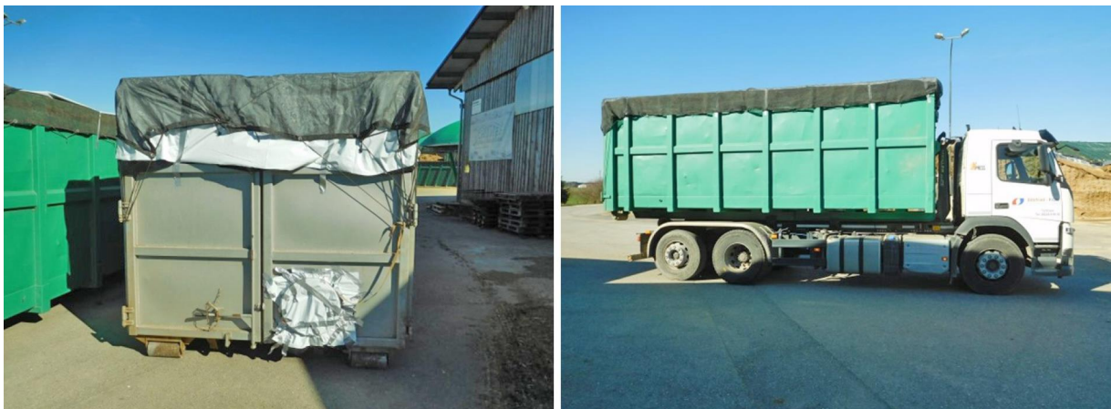
Abbildung 17: Transport der Holzhackschnitzel (links: zum Schutz gegenüber Verschmutzung sorgfältig abgedeckter Trocknungs- bzw. Transportcontainer; rechts: Transport mittels Hakenliftcontainer-Lkw an das TFZ Straubing)
