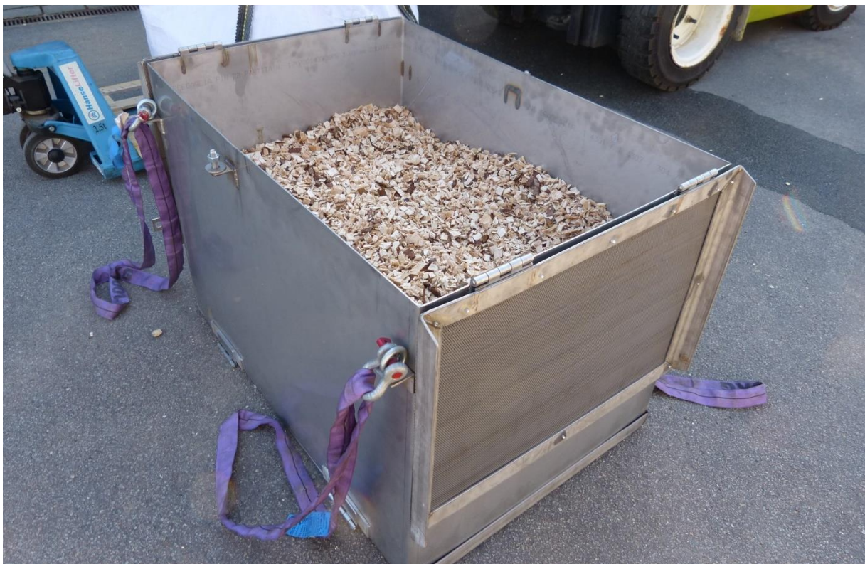
Abbildung 19: Konstruierte Waschbox des TFZ ( 1,0 \times 0,715 \times 0,715 m; Rundlochsieb-einsätze mit 2 mm Lochweite fungieren als Deckel und Boden)
