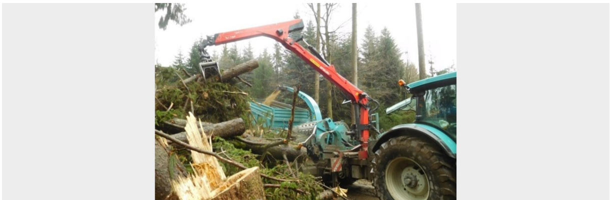
Abbildung 7: Holzhackschnitzelproduktion in Region A: Hacken des Waldrestholzes in Transportcontainer
