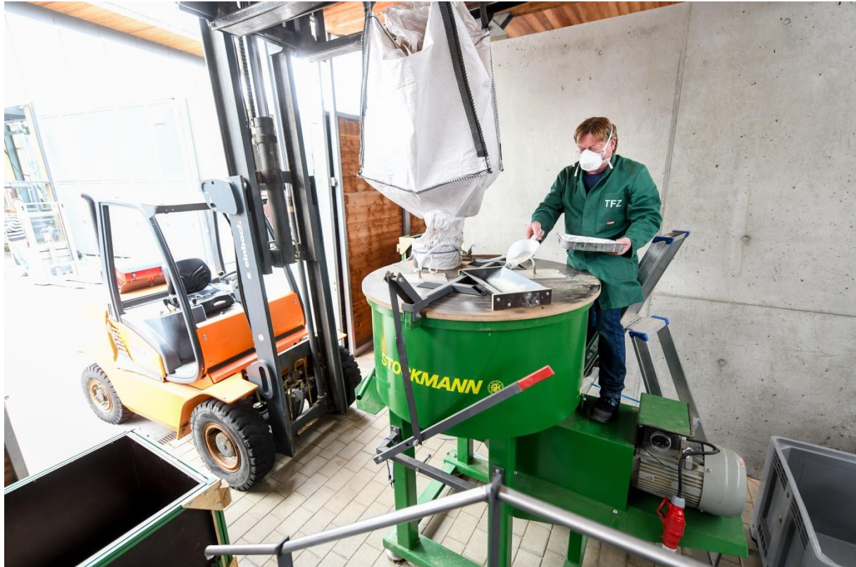
Abbildung 25: Konditionierung zerselter Holz Brennstoffe mit einem Additiv (beispielsweise Mineralboden) im Futtermittelmischer (Stockmann Landtechnik GmbH, Typ 500 ESK)
