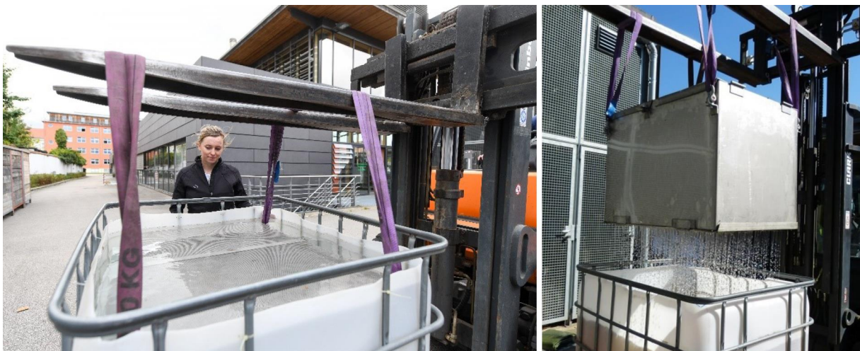
Abbildung 20: Waschvorgang von Holzhackschnitzel mittels der am TFZ konstruierten Waschbox (links: untergetauchte Waschbox; rechts: Abtropfen nach dem wiederholten Untertauchen)
