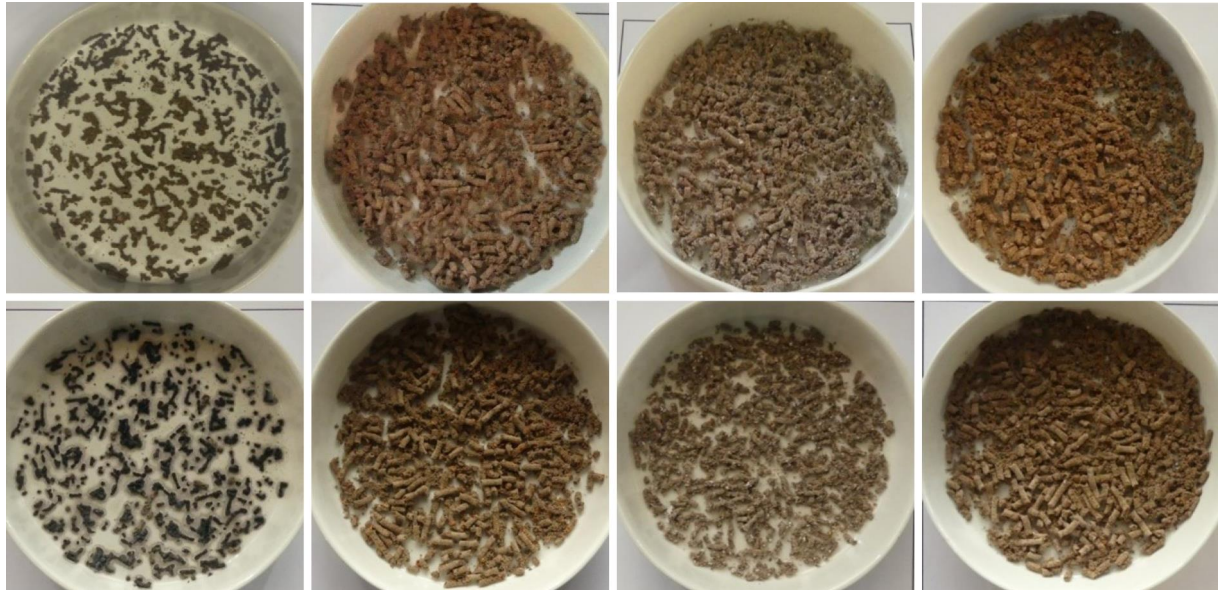
Abbildung 57: Aschen der Pelletbrennstoffe generiert nach der thermischen Behandlung mit der PASSA-Methode (oben: Fichtenbrennstoffe; unten: Buchenbrennstoffe; von links nach rechts: Nullprobe, Mineralboden A, Mineralboden B und Mineralboden C)
