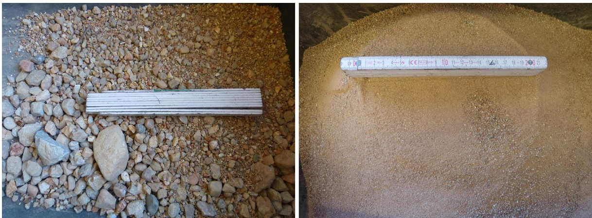
Abbildung 33: Mineralbodenfraktionen nach der Siebung mittels Rüttelsiebmaschine (links: ausgesiebte Fraktionen des Mineralbodens B > 2 mm; rechts: Fraktionen des Mineralbodens B < 2 mm)
