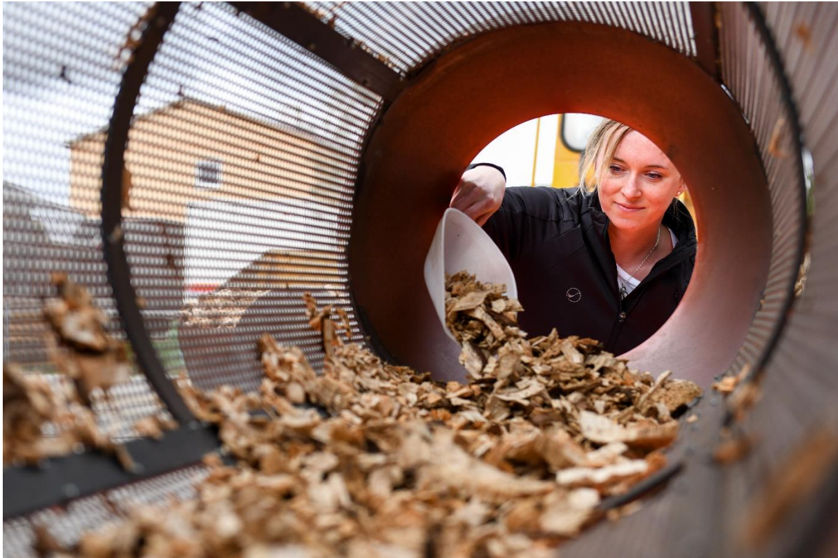
Abbildung 22: Siebung von Holzhackschnitzeln mittels am TFZ gebauter Trommelsiebmaschine
