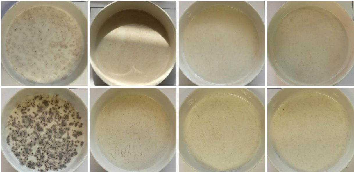
Abbildung 58: Tiegel nach der Entnahme der Aschen der Pelletbrennstoffe, generiert nach der thermischen Behandlung mit der PASSA-Methode (oben: Fichtenbrennstoffe; unten: Buchenbrennstoffe; von links nach rechts: Nullprobe, Mineralboden A, Mineralboden B und Mineralboden C)
