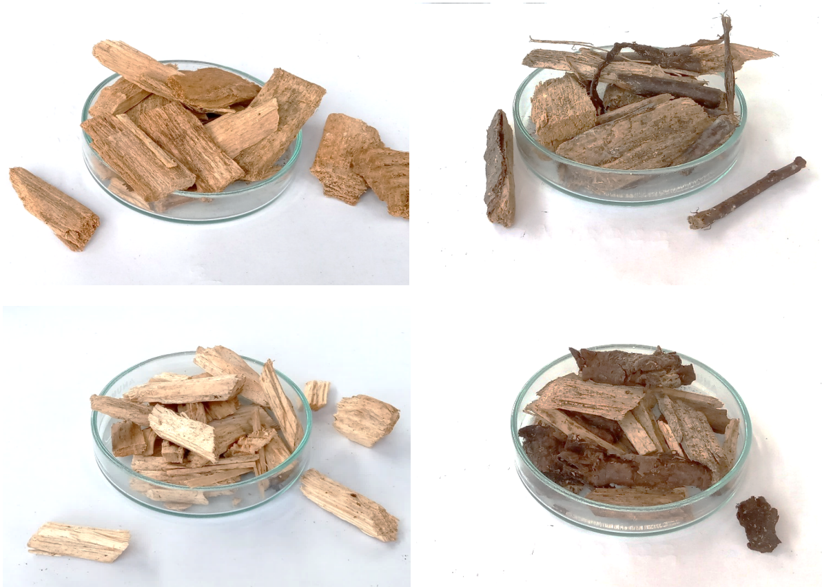
Abbildung 29: Untersuchte Holzhackschnitzel-Qualitäten. Buche Energierundholz (oben links), Buche Waldrestholz (oben rechts), Fichte Energierundholz (unten links), Fichte Waldrestholz (unten rechts)
