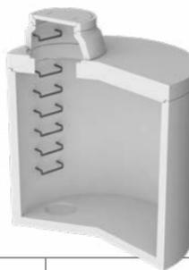
**Anlagenkomponenten:** Betonwanne mit Pumpensumpf in Kompaktbauweise (Bauteilhöhe bis 2 m), Ringe bis 1 m, Betongüte C30/37/XA1L/XA2T, mit Flachabdeckung, Konus 800-600/300/100, Ausgleichsring und Betondeckel (15 kN), 1 Zulaufbohrung mit SBR-Anschlussdichtung DN 150. Eingebaute Poly-Bügel.
