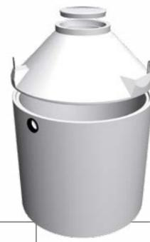
**Anlagenkomponenten:** Betonbehälter in Kompaktbauweise (Bauteilhöhe bis 2,5 m), Betongüte C30/37/XA1L/XA2T, mit Konus und Betondeckel begehbar (15 kN), 1 Zulaufbohrung mit SBR-Anschlussdichtung DN 150.
