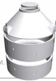
**Anlagenkomponenten:** Sickerschacht in Ringbauweise mit gelochten Schachtringen, oberster Ring ungelocht. Betongüte C30/37/XF1/XA1L, mit Konus und Betondeckel begehbar, ohne Zulaufbohrung.
