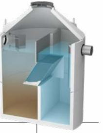
**Anlagenkomponenten:** Monolithischer Betonbehälter, Betongüte C35/45/XA1L/XA2T, mit Mitteltrennwand, mit Konus/ Flachabdeckung mit Minikonen und befahrbarem/n Gussdeckel/n, Zu- und Ablaufbohrung mit SBR-Anschlussdichtung, Zulaufberuhigung, eingebaute Parallelplatten, Ablauftauchrohr.
