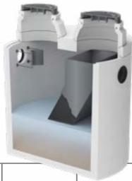
**Anlagenkomponenten:** Monolithischer Betonbehälter, Betongüte C35/45/XA1L/XA2T, mit Flachabdeckung, Konen und befahrbarem Gussdeckel, Zu- und Ablaufbohrung mit SBR-Anschlussdichtung, Zulaufberuhigung, eingebaute Parallelplatten.
