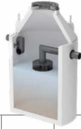
**Anlagenkomponenten:** Monolithischer Betonbehälter, Betongüte C30/37/XA1L/XA2T, mit Flachabdeckung, Konen und befahrbarem Gussdeckel, Zu- und Ablaufbohrung mit SBR-Anschlussdichtung, Zulaufumlenkung, zentrales, getauchtes Abzugsrohr mit radialer Anströmung.
