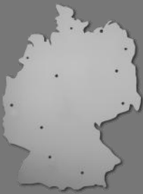
Deutschlandkarte - Nibbelteil German map - nibble from sheet metal
