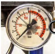
Erhöhter Luftdruck zur Kompensation niedriger Schweißkraft
