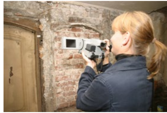
09.18 Messung mit der Wärmebildkamera
