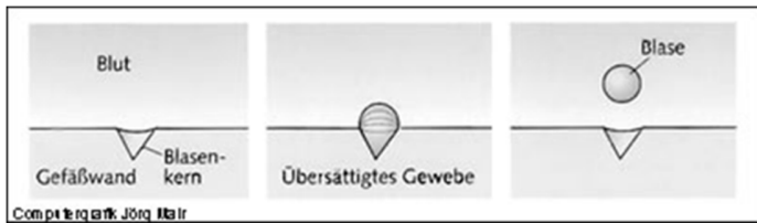
Abb. 2: Entstehung von Gasblasen aus einer flüssigen Lösung an Oberflächendefekten des Gefäßes. Die Blasen wachsen an diesen Stellen, bis der Auftrieb die Adhäsion überwiegt. Dann lösen sie sich ab und eine neue Blase kann sich an dieser Stelle bilden. Diese Abbildung ist von J. Mair 3) .
