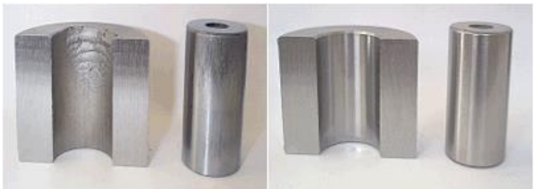
Foto: Zug-Druck-Prüfmaschine (oben) Übersicht des Verfahrens (mitte) Bolzen mit Matrize vorher (u.r.) und nachher (u.l.)
