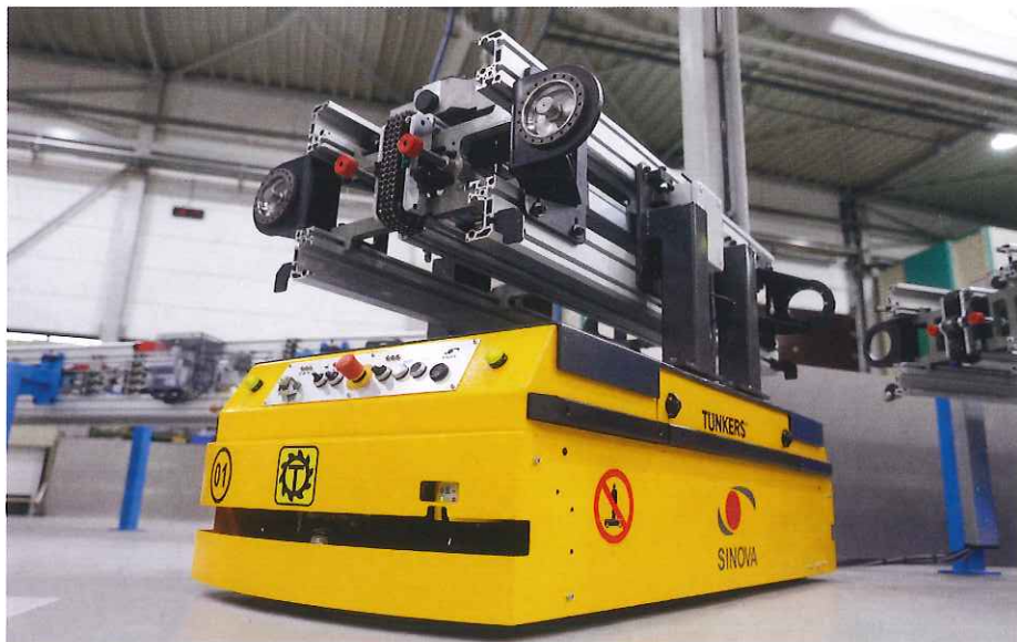
Das frei navigierbare Stauförder-FTF ist eine Tünkers-Entwicklung, mit der eine freie Gestaltung des Werks- oder Zellenlayouts möglich wird.
