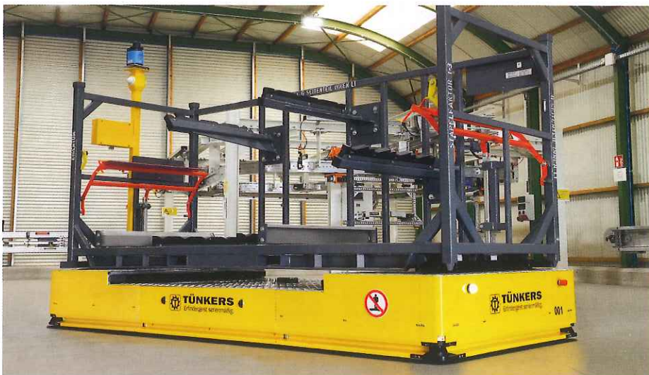
Mit Hilfe von Fahrerlosen Transportsystemen können verschiedene Formate, wie zum Beispiel Großteile (Seitenwände oder Bodengruppen), als Einzelteil auf Trägern/Skids oder mit direkter Aufnahmetechnik/Spanntechnik (Unterbau) befördert werden.
