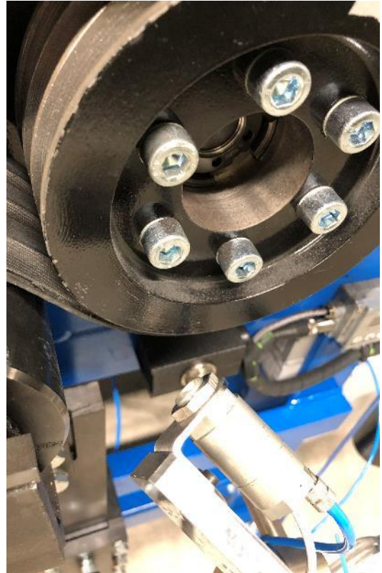
Bild 27: HBM-Drehmoment- und Drehzahlsensor Bild 28: IR-Temperatursensor
