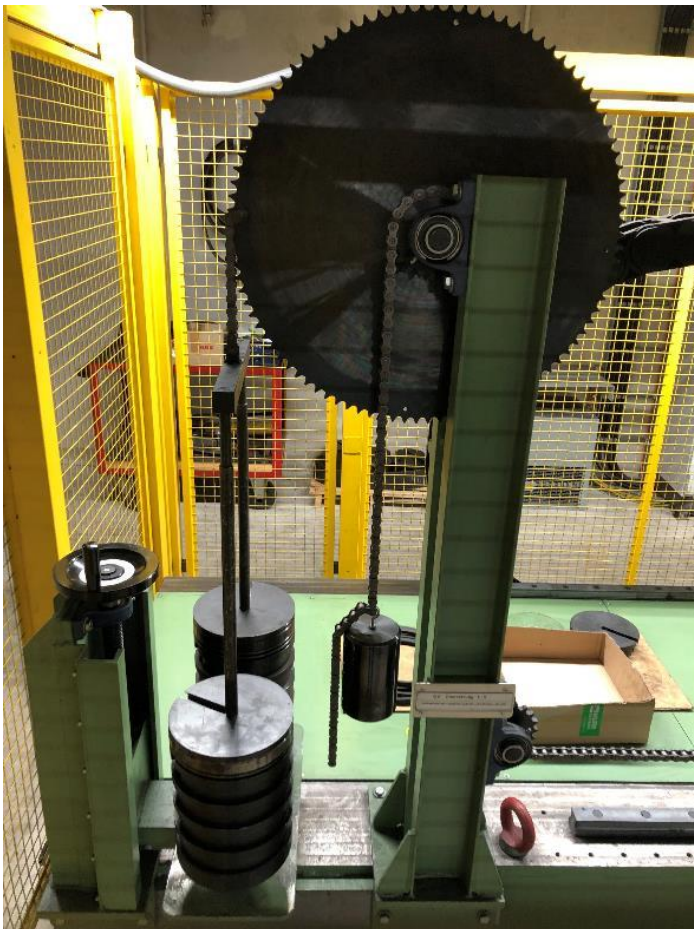
Bild 20: Vorspannungsaufbringung durch Gewichte am Motor-Generator-Prüfstand
