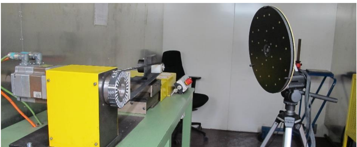
Bild 29: Schallmesskamera vor VDA-Geräusch-Prüfstand in einer Metallzelle
