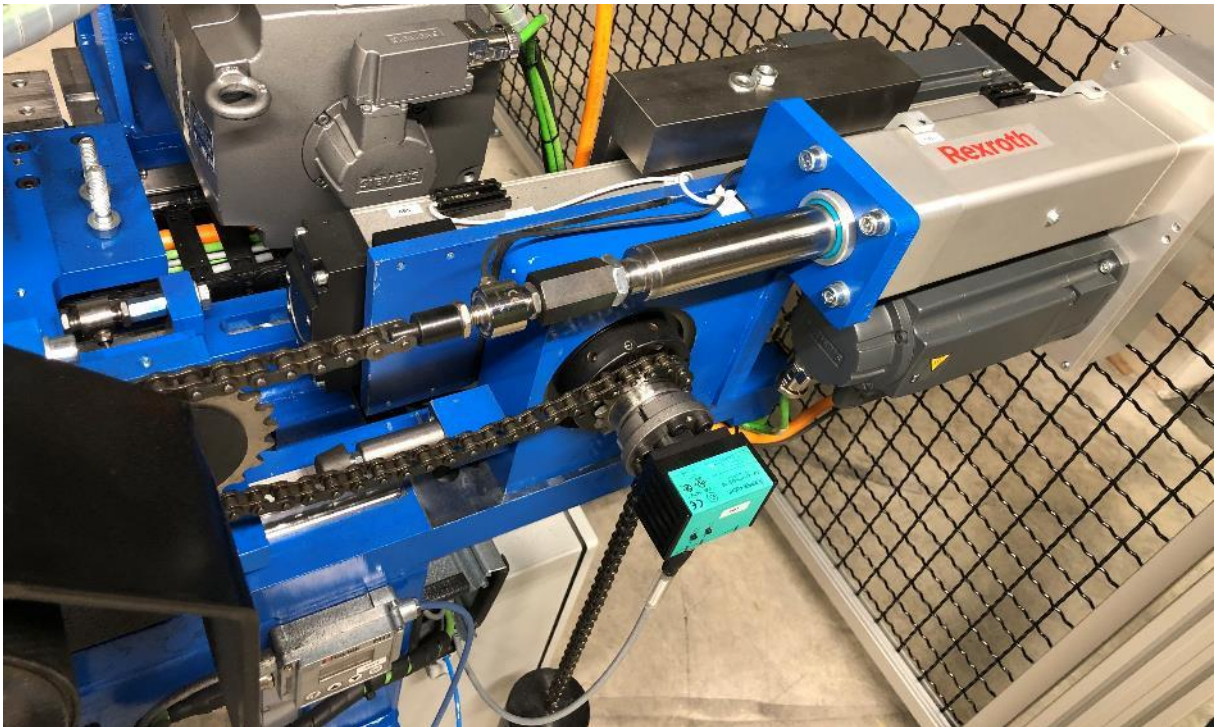
Bild 22: Motorisierte Vorspannungsaufbringung an einem 55-kW-Verspann-Prüfstand
