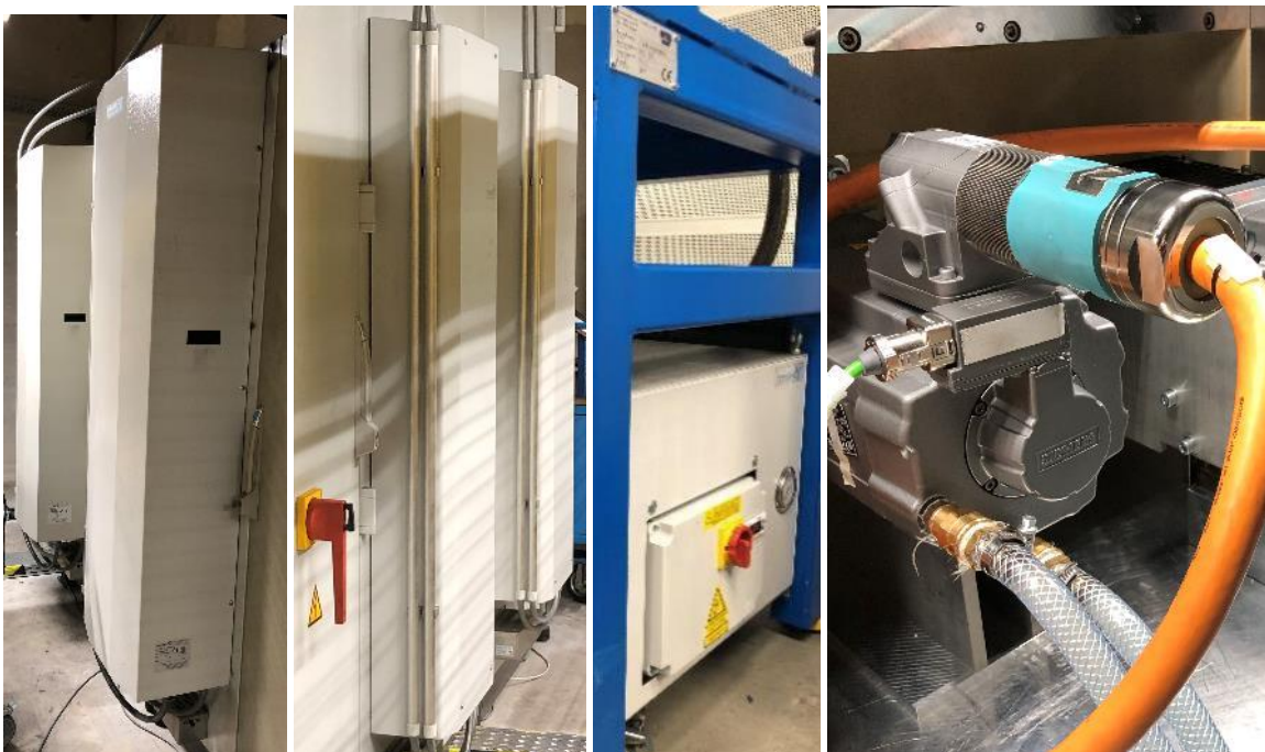
Bild 11: v.l.n.r.: Huckepack-Wasser-Luft-Wärmetauscher an den alten 250-kW- und am 90kW-Motor-Generator-Prüfständen, Wasser-Wasser-Wärmetauscher am neuen 200-kW-
