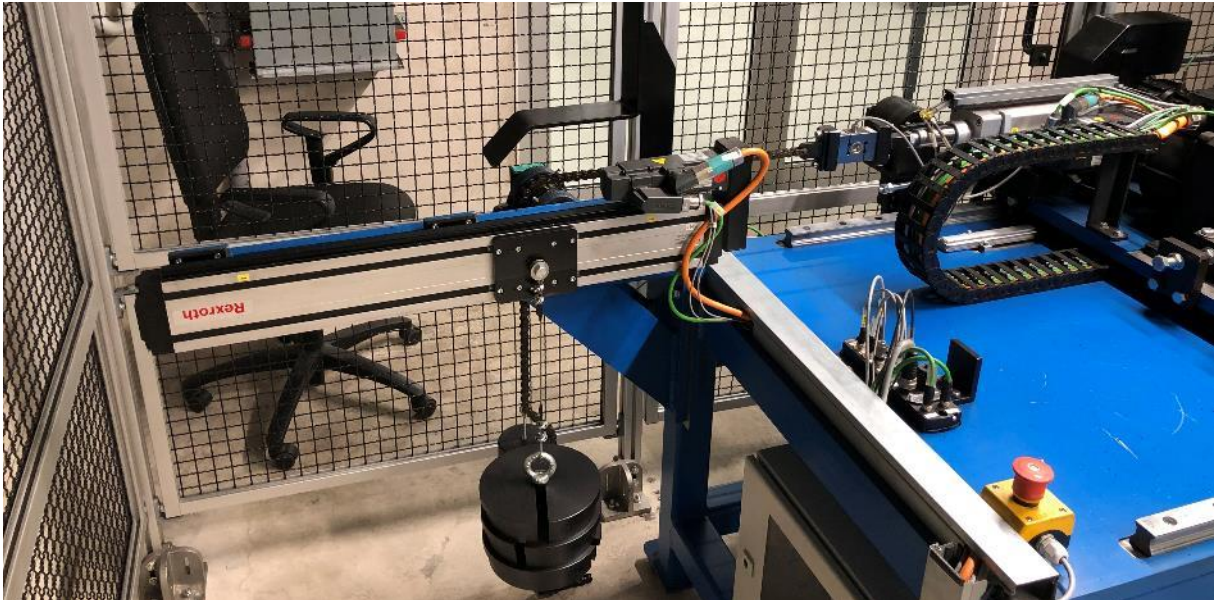
Bild 21: Motorisierte Vorspannungsaufbringung am 30-kW-Pilot-Verspann-Prüfstand
