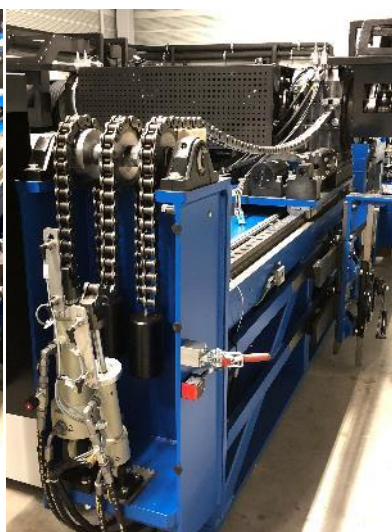
Bild 24: Vorspann-Hydraulik am 1.000-kW-Verspann-Prüfstand (s. Kap. 2.1)
