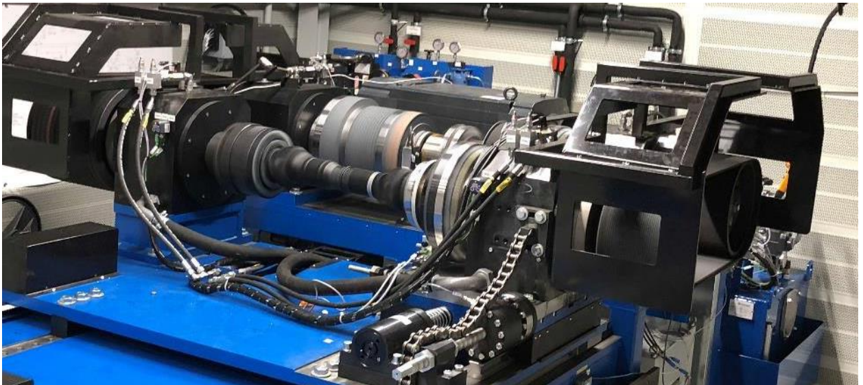
Bild 10: Servo-verspannter Prüfstand mit 1.000 kW Dauer- / 1.800 kW Spitzenleistung vor „Abprüfen“ einer Dauerleistung von 500 kW mit einem Prüfzahnriemen (rechts)
