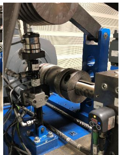
Bild 25: Vorspann-Hydraulik am Verspann-Riementrieb am Funktionsprüfstand (s. Kap. 2.3)
