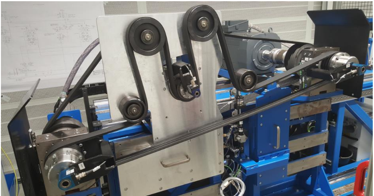
Bild 40: Funktionsprüfstand im zweiten Layout mit Rückenrollen-Nebenantrieb
