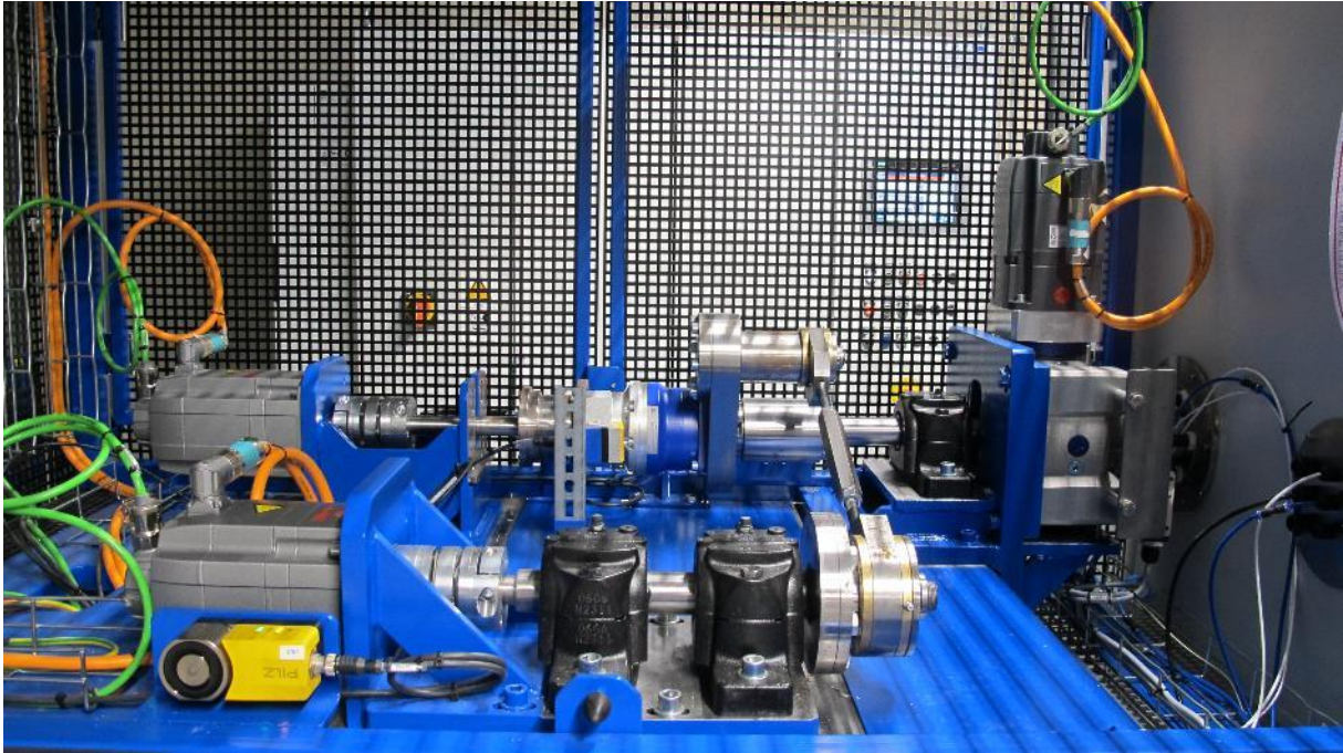
Bild 38: Antriebe des Reibwert-Prüfstands:
