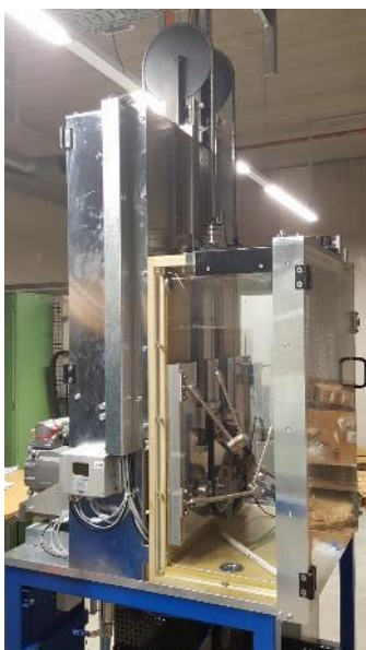
Bild 35: SAE-Geräusch- & Reib- Bild 36: Motoren SAE-Geräusch- & Reibwert-Prüfstand, links
