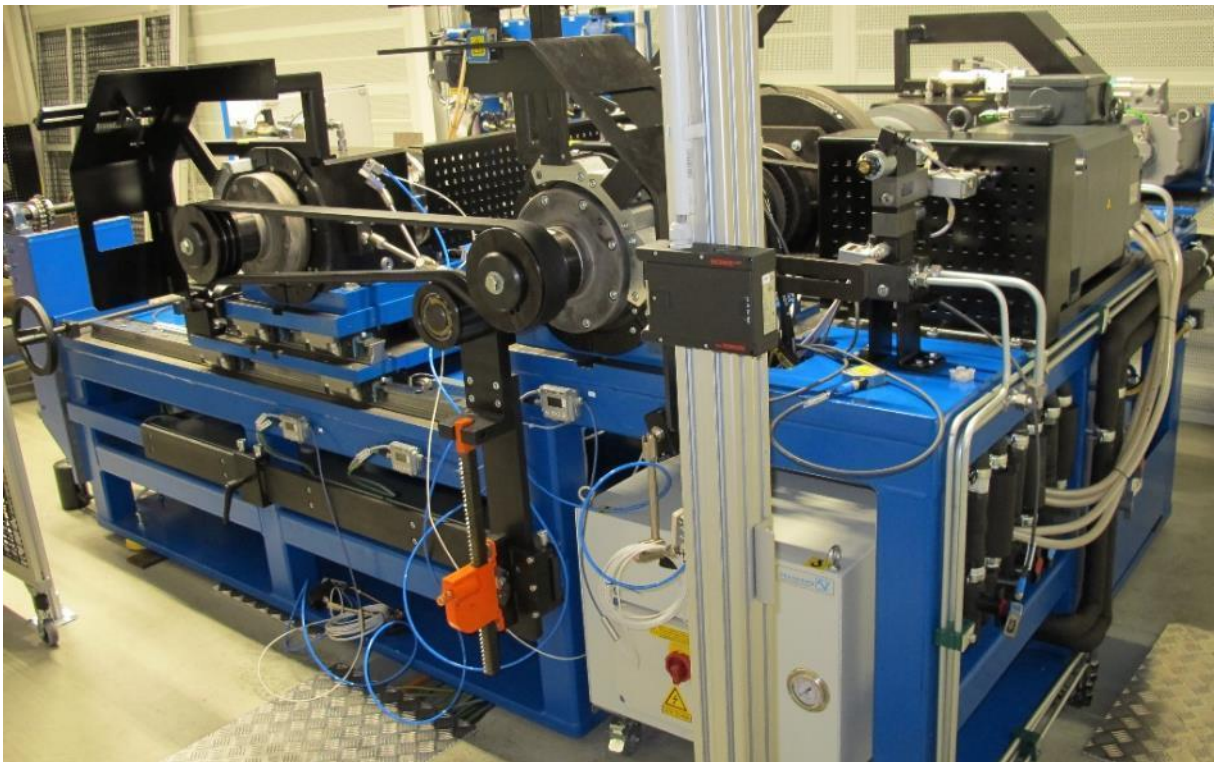
Bild 9: Servo-verspannter Keilriemen-Prüfstand mit 200 kW Dauer- / 400 kW Spitzenleistung
