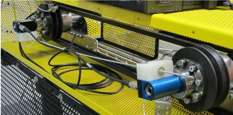
Bild 31: Lorenz-Drehmomentsensoren im Verlustleistungsprüfstand
