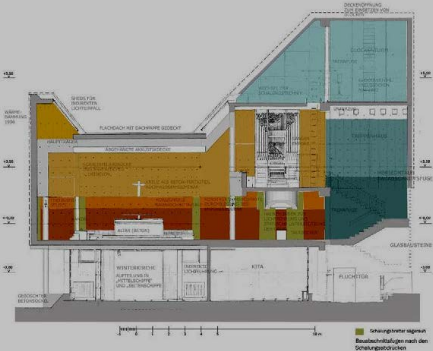
Berlin, Apostel-Johannes-Kirche, Querschnitt mit Bauabschnittsfugen und Oberflächenbehandlung des Betons. Bauaufnahme-Übung TU Berlin 2005, Betreuung: Blümel, Breitling, Kannenberg.
