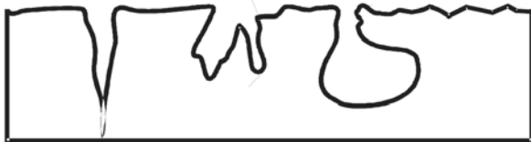
Bild 102: Formen der Lochkorrosion
