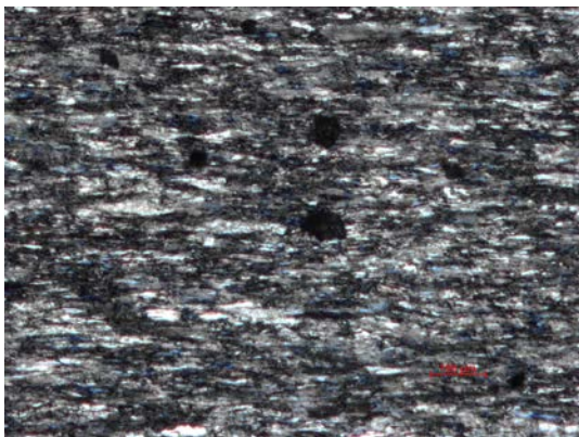
Bild 37: Ausgerichtetes Gefüge eines kalt verformten Spannstahls St 1080/1330
